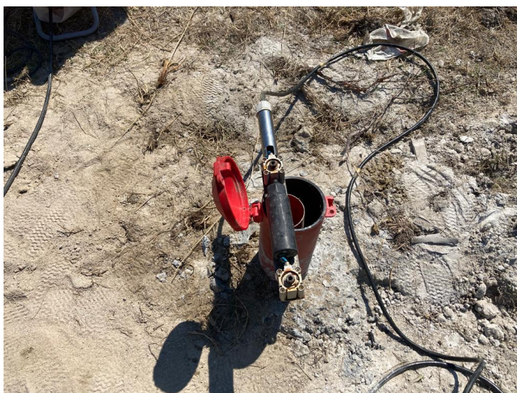
Geofono tridimensionale con evidenza dei pistoni di ancoraggio
