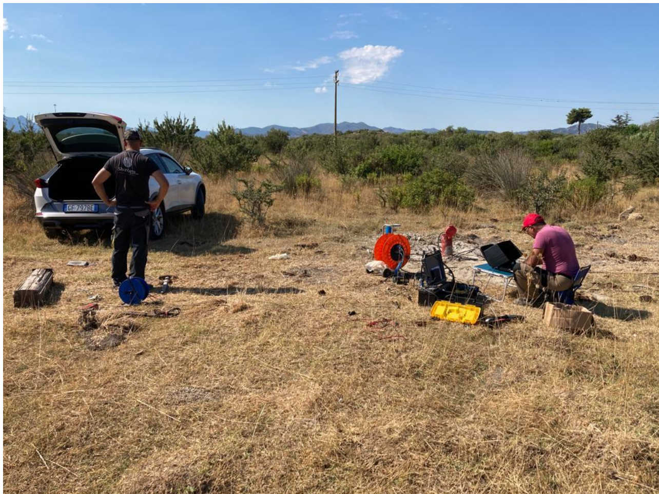
Sistema di energizzazione e di acquisizione onde sismiche in foro
