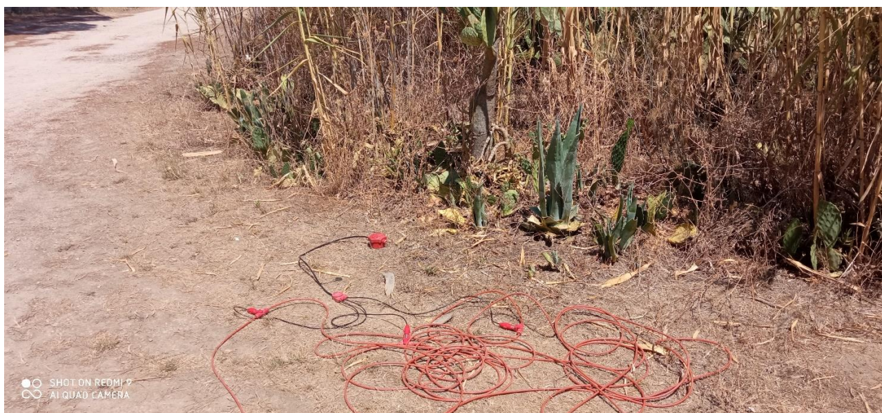
Misurazione del rapporto spettrale HVSR3
