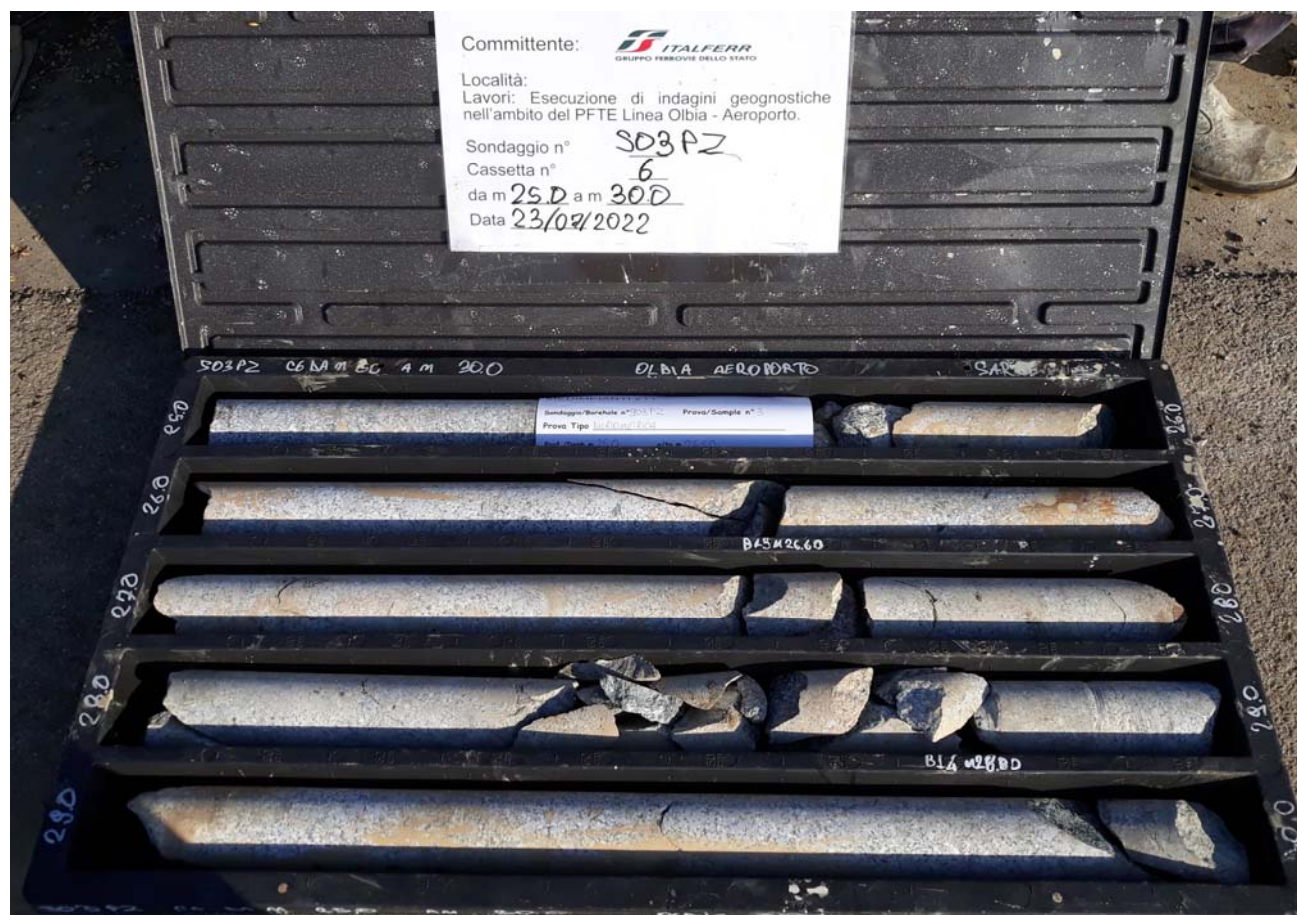
Sondaggio n° S03 PZ Cassetta Catalogatrice n° 6 da 25,00 m 30,00
