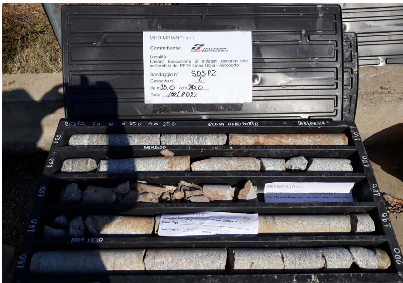
Sondaggio n° S03 PZ Cassetta Catalogatrice n° 4 da 15,00 m 20,00
