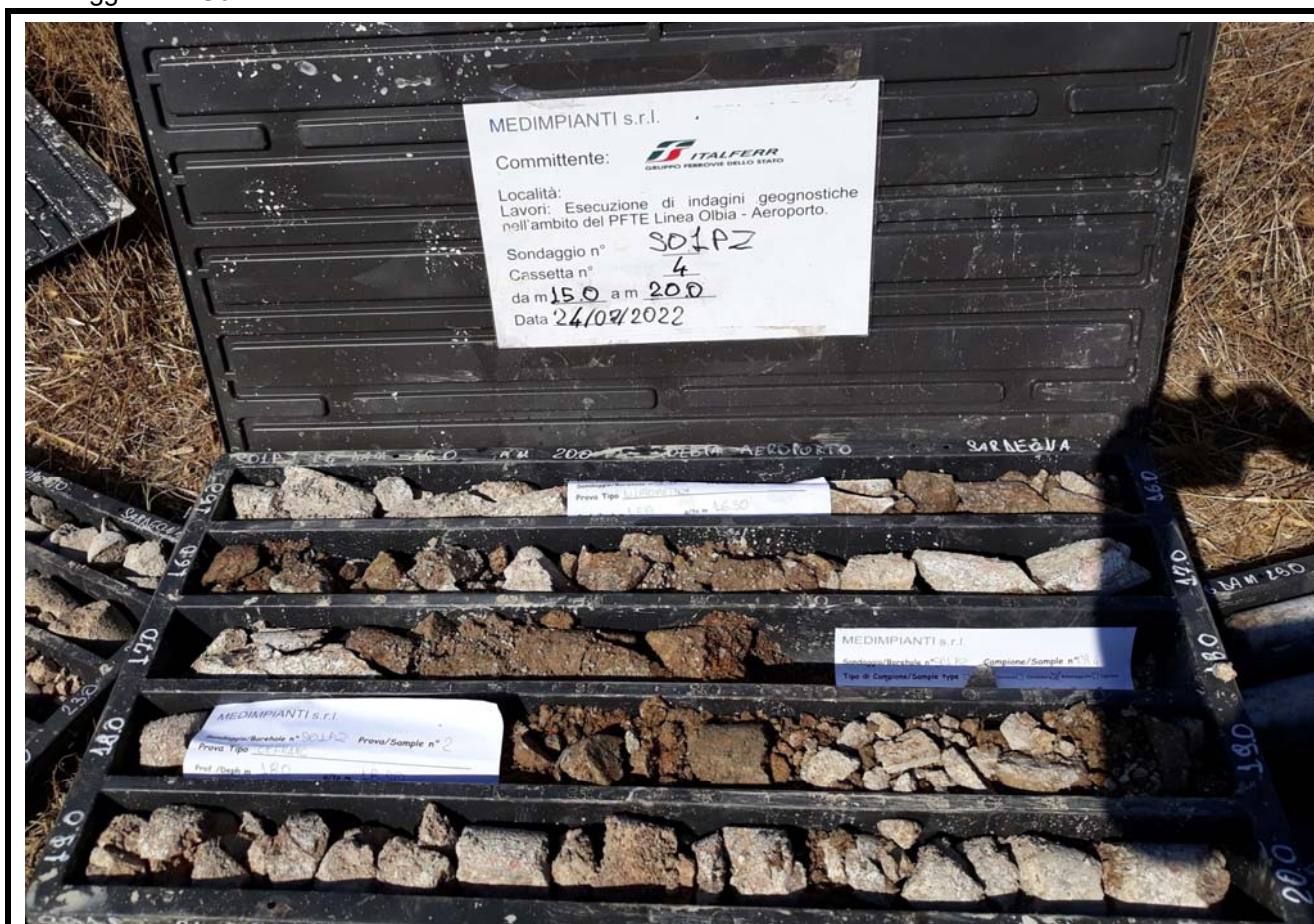
Sondaggio n° S01 PZ Cassetta Catalogatrice n° 4 da 15,00 m 20,00
