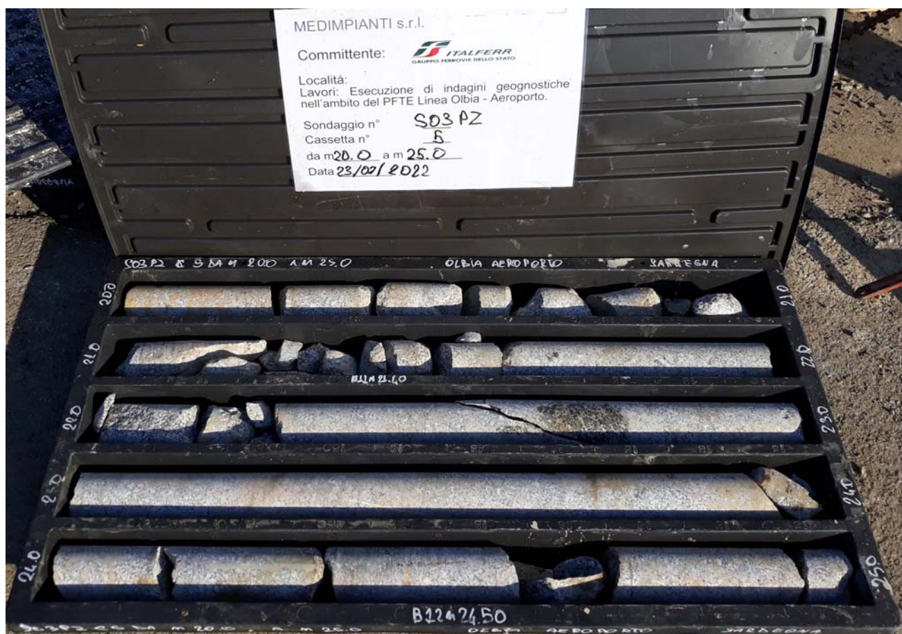
Sondaggio n° S03 PZ Cassetta Catalogatrice n° 5 da 20,00 m 25,00
