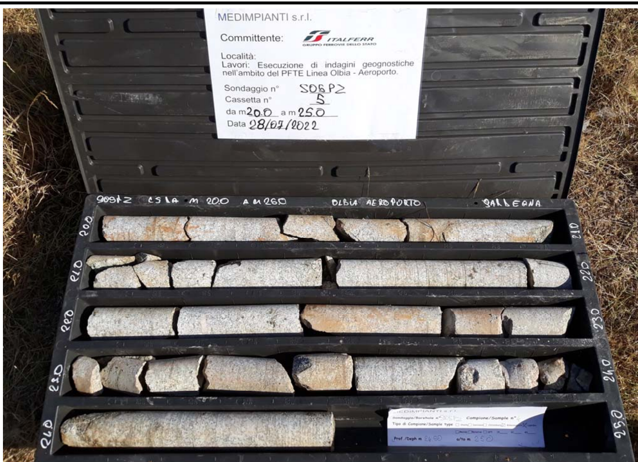
Sondaggio n° S05 PZ Cassetta Catalogatrice n° 5 da 20,00 m 25,00
