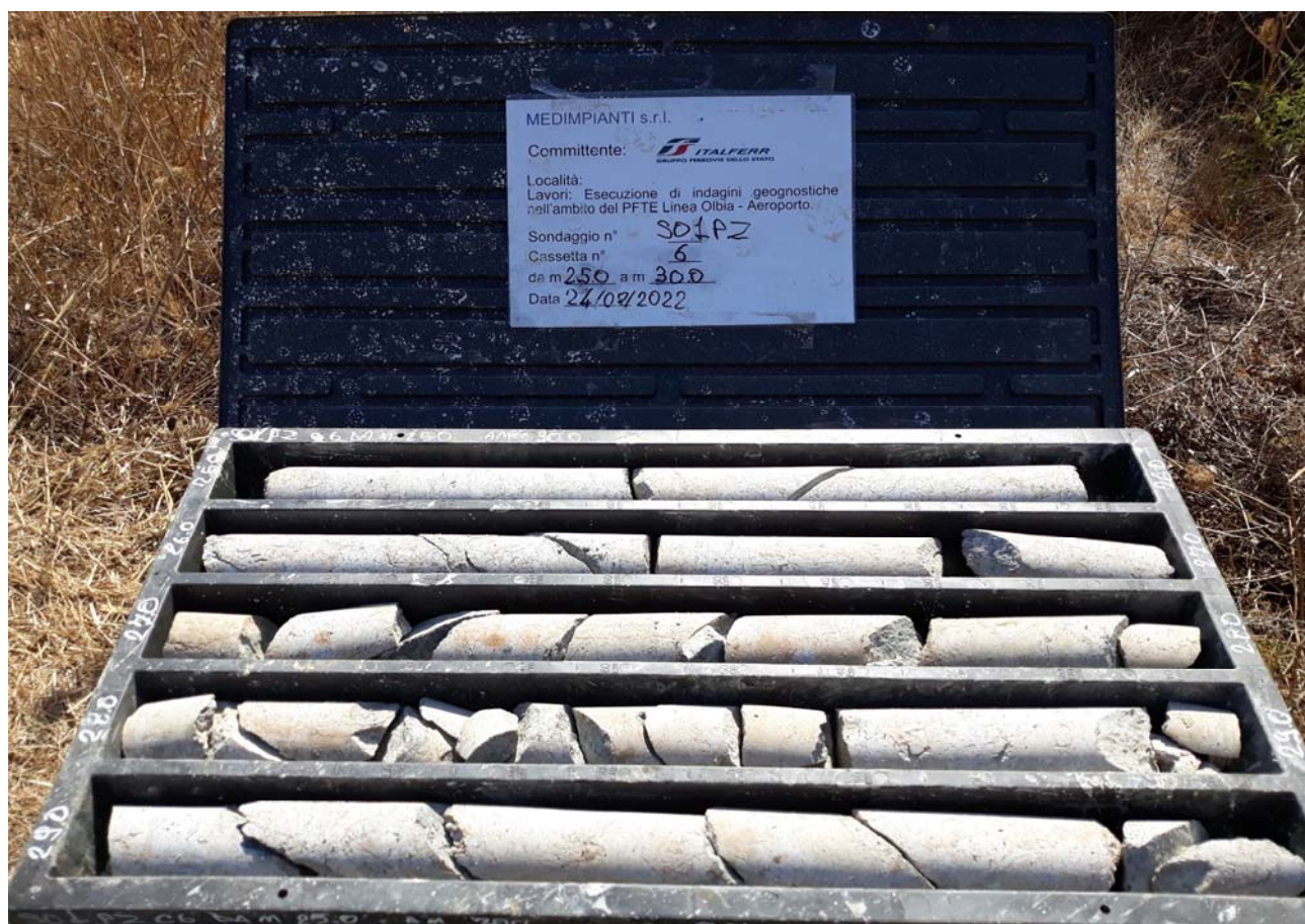
Sondaggio n° S01 PZ Cassetta Catalogatrice n° 6 da 25,00 m 30,00
