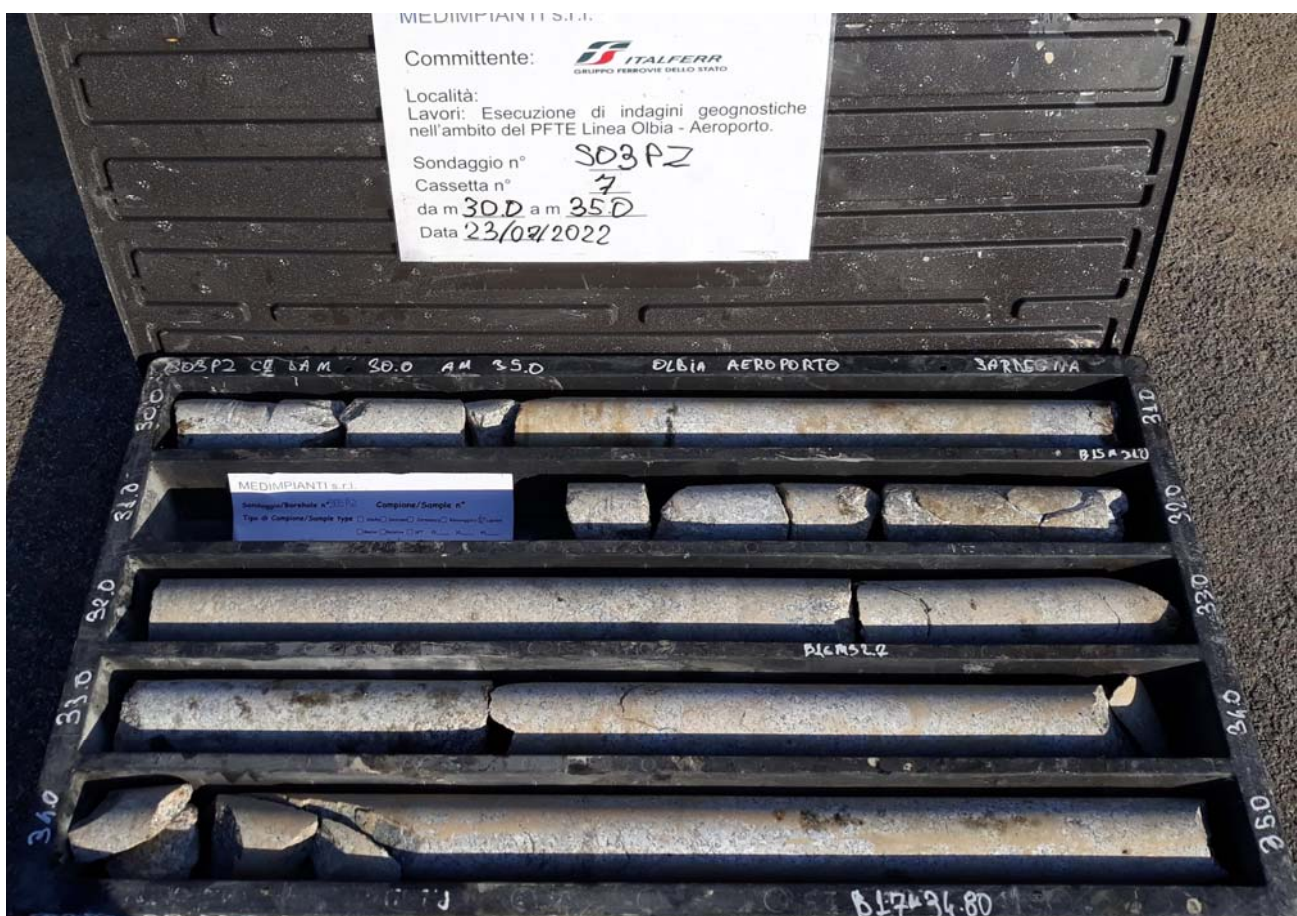
Sondaggio n° S03 PZ Cassetta Catalogatrice n° 7 da 30,00 m 35,00
