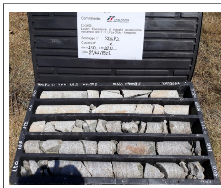
Foto cassetta tratto di prova
