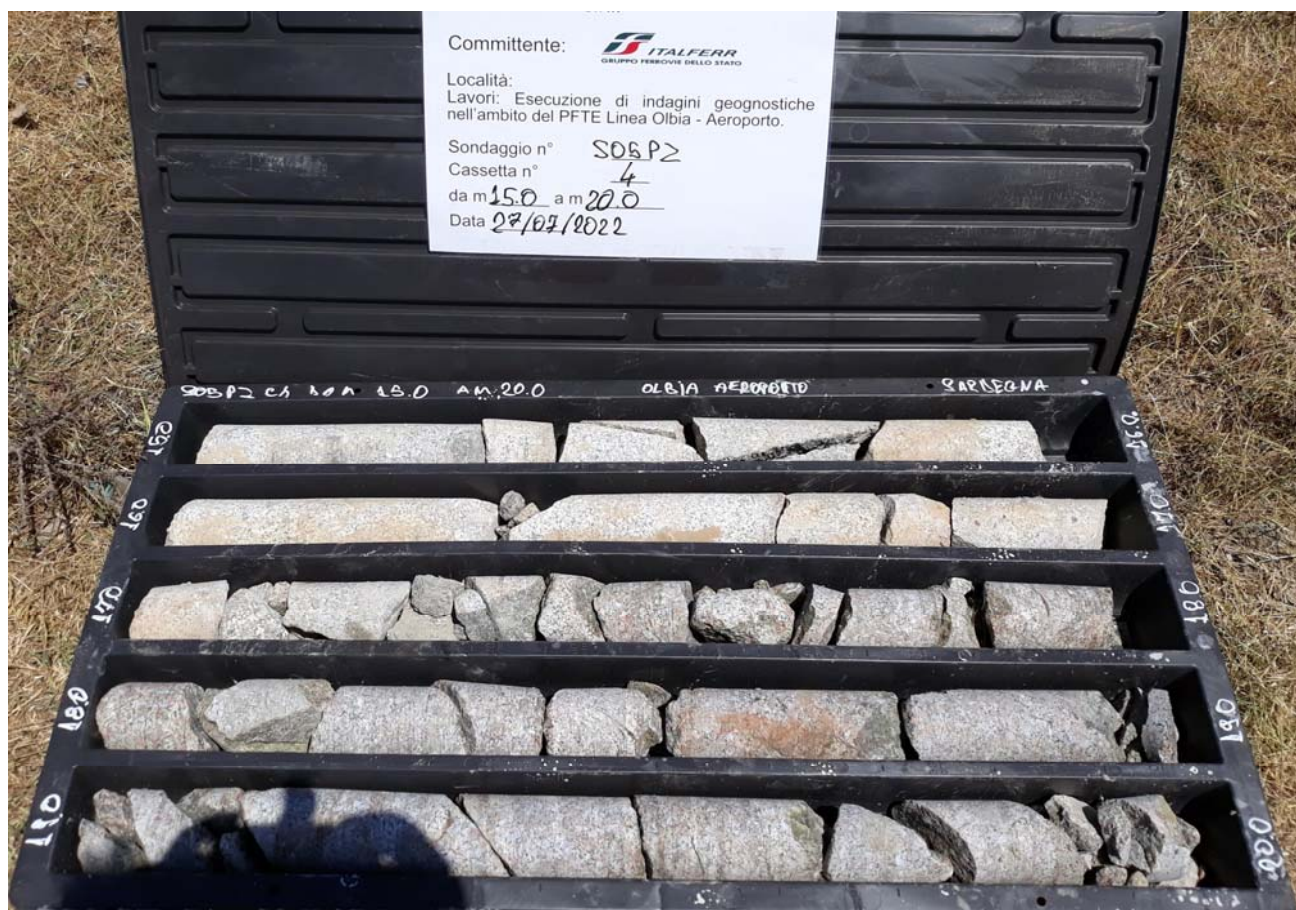
Sondaggio n° S05 PZ Cassetta Catalogatrice n° 4 da 15,00 m 20,00
