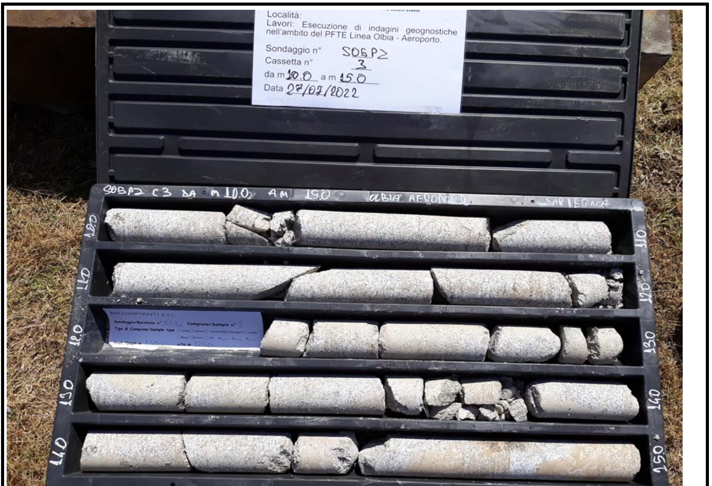
Sondaggio n° S05 PZ Cassetta Catalogatrice n° 3 da 10,00 m 15,00
