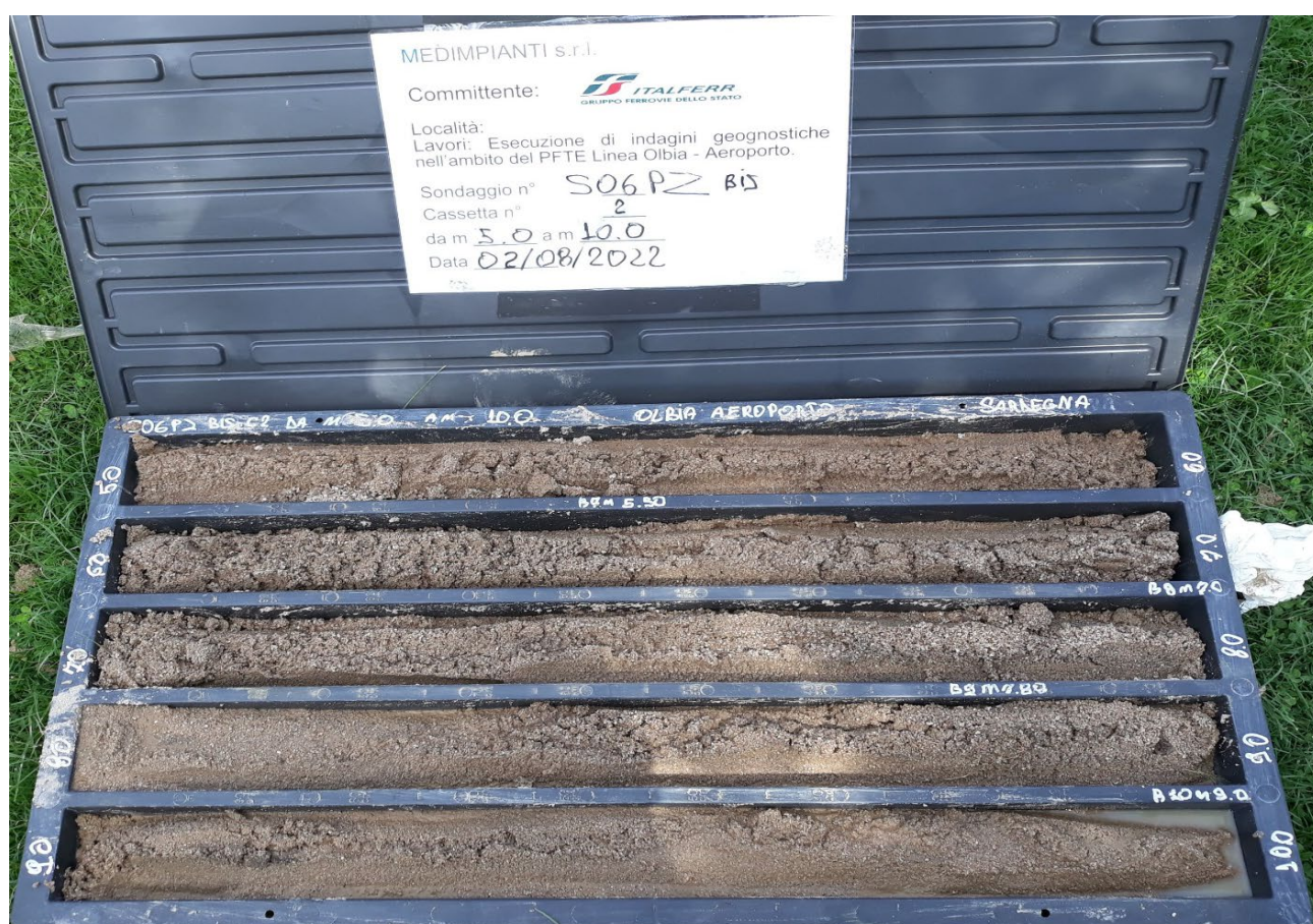
Sondaggio n° S06 Bis F Cassetta Catalogatrice n° 2 da 5,00 m 10,00
