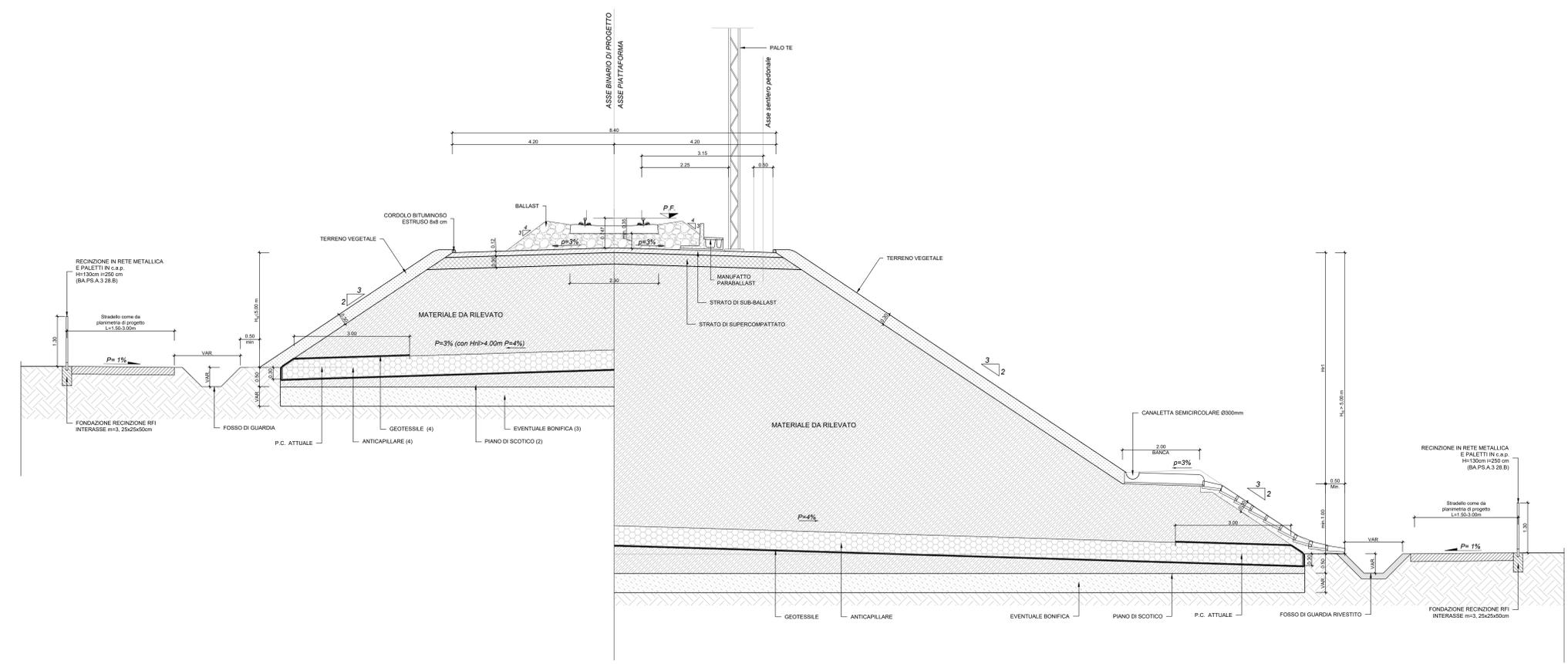
Pianta per sezione tipo in rilevato singolo binario con e senza barriere Antirumore
