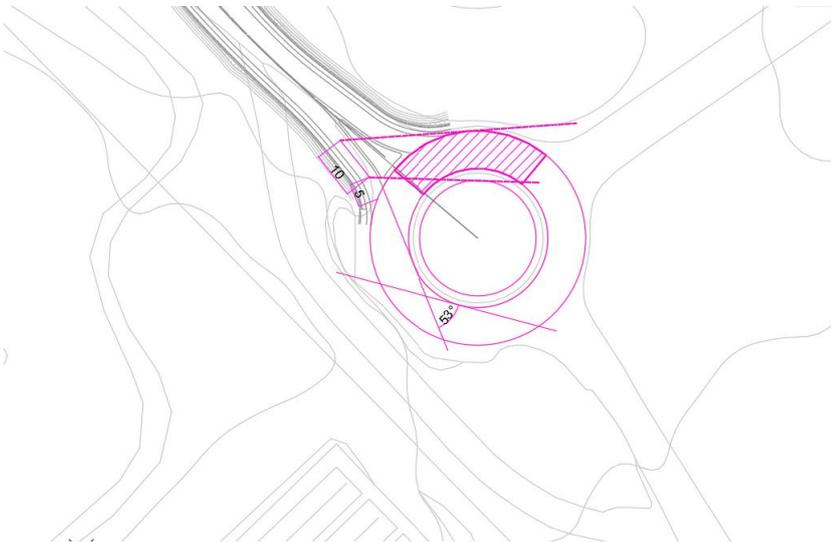
La rotatoria Nord si configura come adeguamento di intersezione esistente, dunque il D.M. 19/04/2006 è riferimento alla progettazione ma non è cogente. Inoltre, secondo quanto definito al paragrafo 4.5.3 del suddetto D.M., la verifica degli angoli di deviazione non ha valore prescrittivo ma di raccomandazione.
