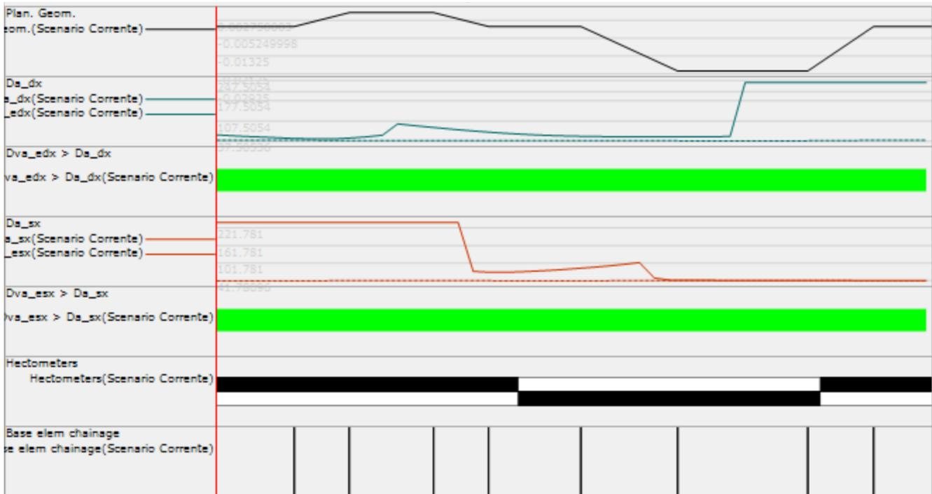
Con riferimento all'andamento plano-altimetrico della viabilità NV03, la verifica delle distanze di visuale libera è stata condotta verificando che lungo il tracciato sia garantita la distanza di visuale libera richiesta per l'arresto.
