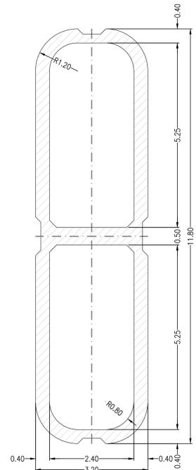
PILA. SEZIONE TRASVERSALE
