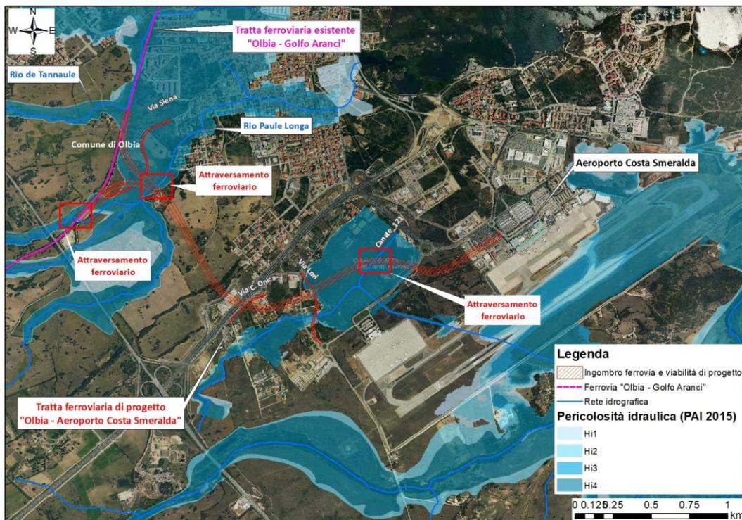
Figura 1 - Aree soggette a pericolosità idraulica ai sensi del Piano di Assetto Idrogeologico 2015, perimetrare a tutela della salute umana e del territorio dal rischio di esondazione.
