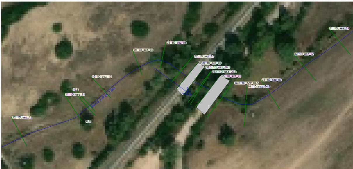
Figura 25 Planimetria del modello 1D in HEC-RAS.
