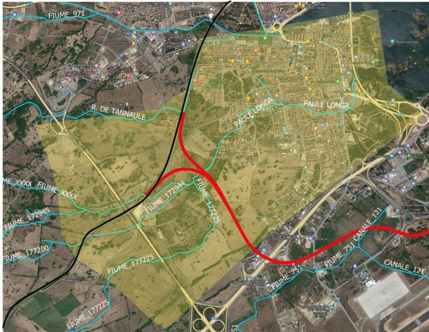
Figura 2 – Estensione del dominio di calcolo (in giallo), linea ferroviaria esistente (in nero), linea ferroviaria in progetto (in rosso)
