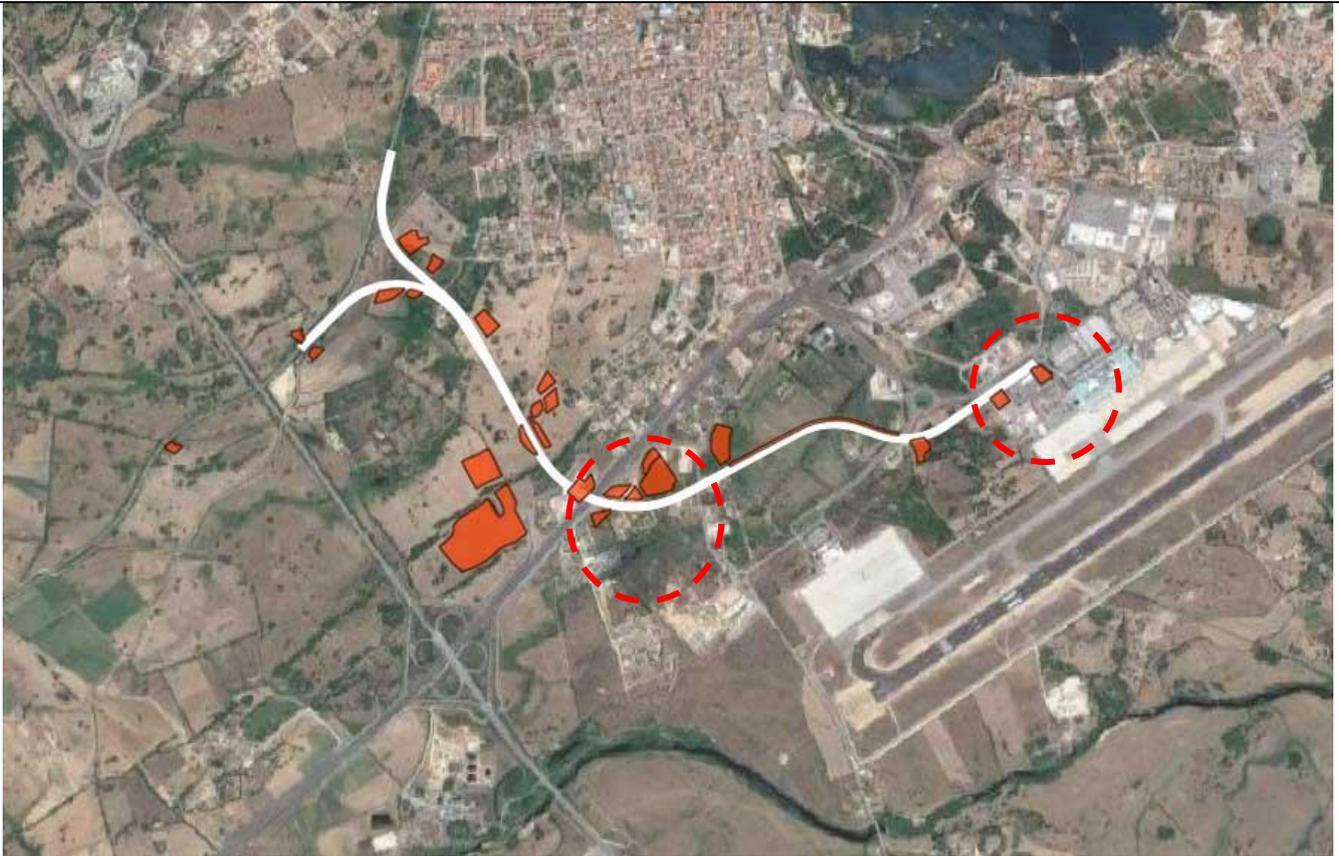
Le aree di cantiere fisso previste in questo ambito attengono ad aree tecniche, finalizzate alla realizzazione dell'opera; cantieri base, che contengono la logistica a supporto delle maestranze e gli impianti e le attrezzature necessarie per lo sviluppo delle attività ed aree di stoccaggio.
