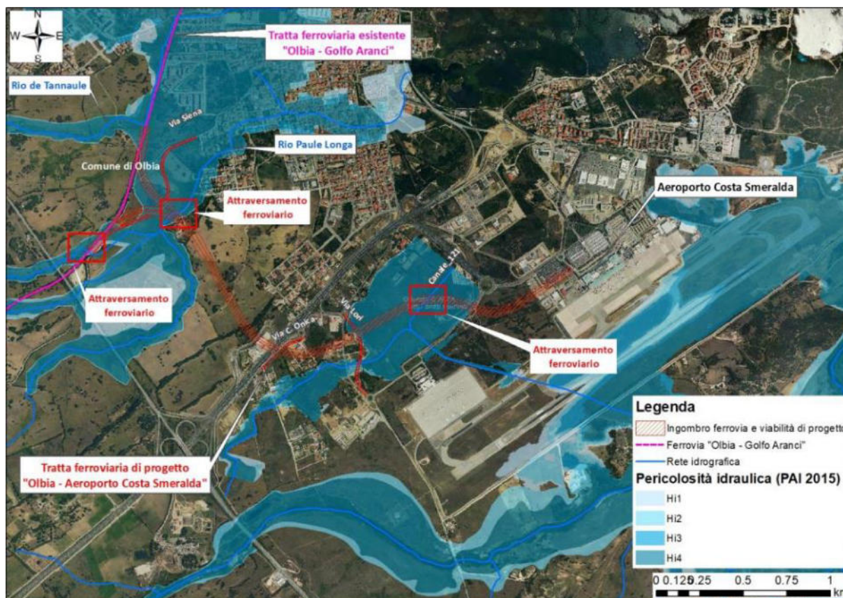
Figura 5-9 Aree soggette a pericolosità idraulica ai sensi del Piano di Assetto Idrogeologico 2015, perimetrare a tutela della salute umana e del territorio dal rischio di esondazione.
