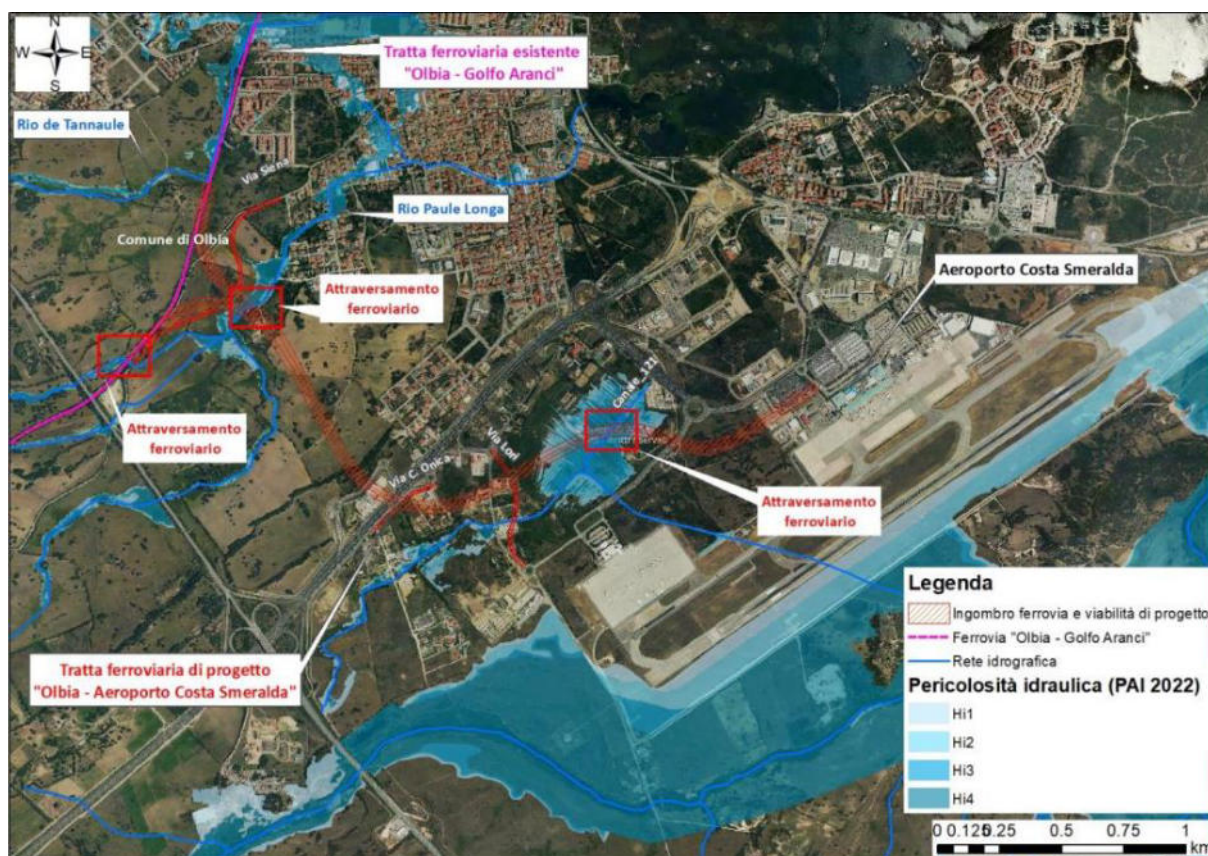
Figura 5-10 Aree soggette a pericolosità idraulica ai sensi degli studi svolti dal comune di Olbia per il prossimo aggiornamento PAI.
