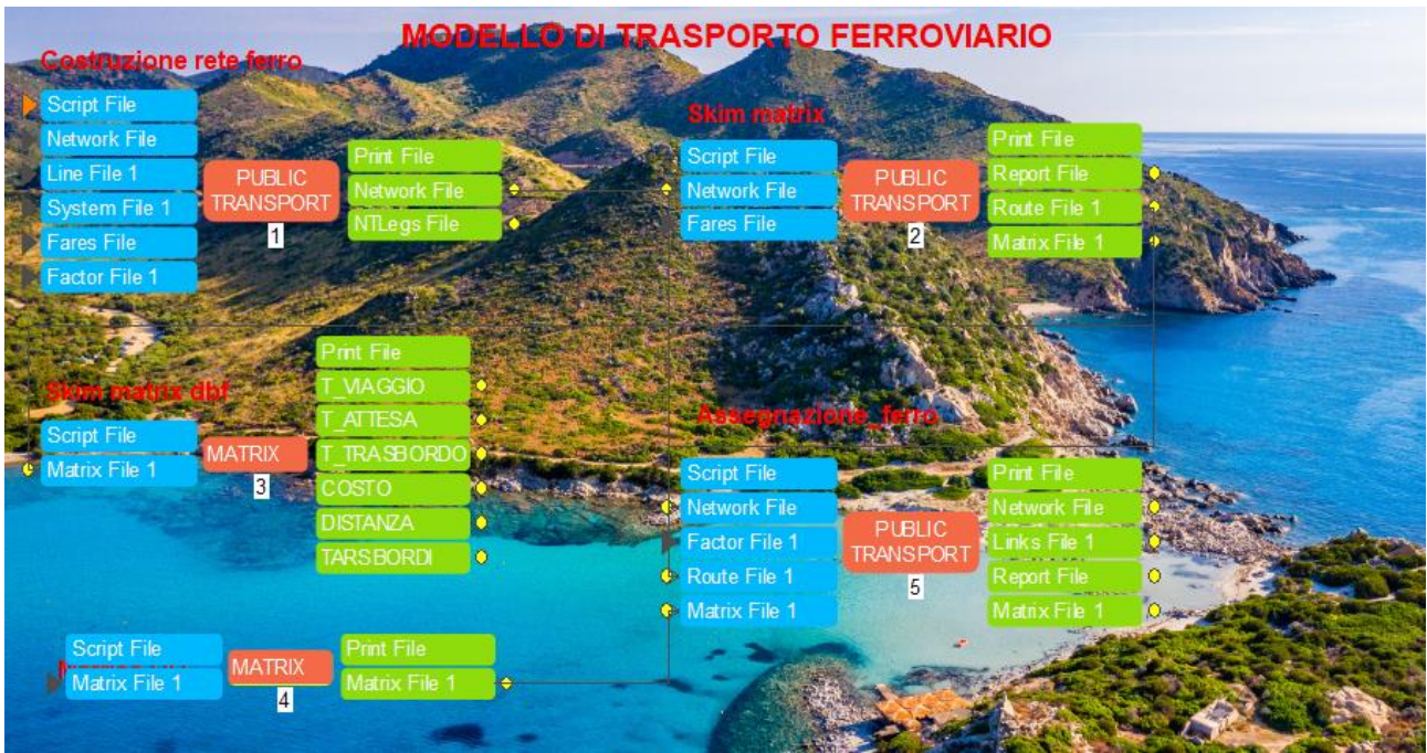
Figura 7.14 – Architettura del sistema di modelli implementata in SW CUBE per la componente regionale
