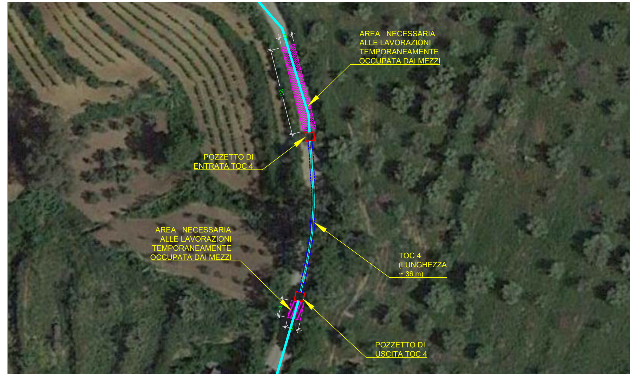
ALLESTIMENTO CANTIERE TOC 4
