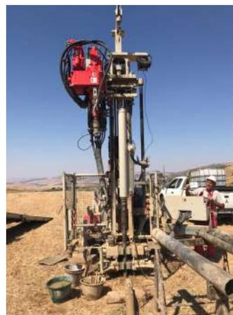
La perforazione è stata eseguita con l'ausilio di carotieri semplice con diametro 101 mm, con l'ausilio di fluido di circolazione.
