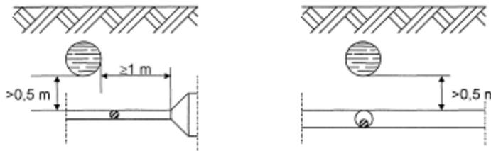
Tale distanza può essere ridotta fino ad un minimo di 0,30 m nel caso in cui una delle strutture di incrocio è contenuta in un manufatto di protezione non metallico prolungato almeno 0,30 m per parte rispetto all'ingombro in pianta dell'altra struttura (vedasi figure seguenti).
