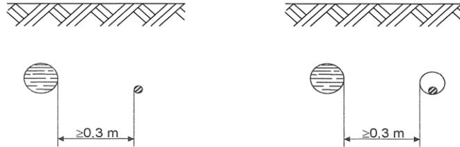
**3.13.4 Incroci e parallelismi tra cavi di energia in tubazione e tubazioni di gas con densità non superiore a 0,8 non drenate con pressione massima di esercizio >5 Bar**
