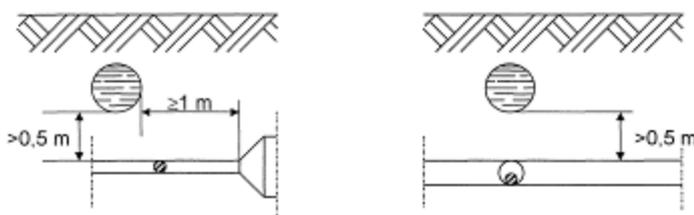
Tale distanza può essere ridotta fino ad un minimo di 0,30 m nel caso in cui una delle strutture di incrocio è contenuta in un manufatto di protezione non metallico prolungato almeno 0,30 m per parte rispetto all'ingombro in pianta dell'altra struttura (vedasi figure seguenti).
