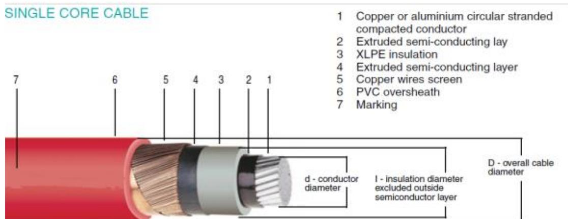
**Figura 2: Caratteristiche cavi MT**
