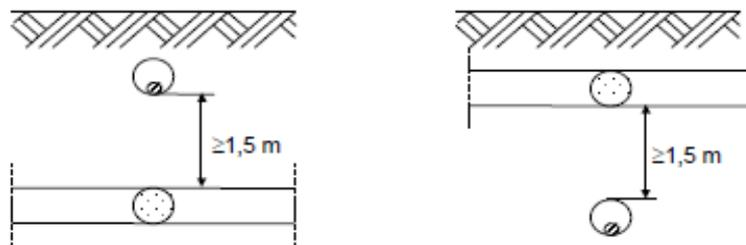
Qualora non sia possibile osservare tale distanza, la tubazione del gas deve essere collocata entro un tubo di protezione che deve essere prolungato da una parte e dall'altra dell'incrocio per almeno 1 m nei sottopassi e 3 m nei sovrappassi; le distanze vanno misurate a partire dalle tangenti verticali alle pareti esterne della canalizzazione; in ogni caso deve essere evitato il contatto metallico tra le superfici affacciate (vedasi figure seguenti).
