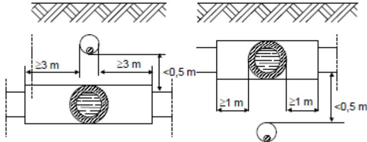
Nei casi di percorsi paralleli tra canalizzazioni per cavi elettrici e tubazioni del gas la distanza misurata tra la due superfici affacciate deve essere:
