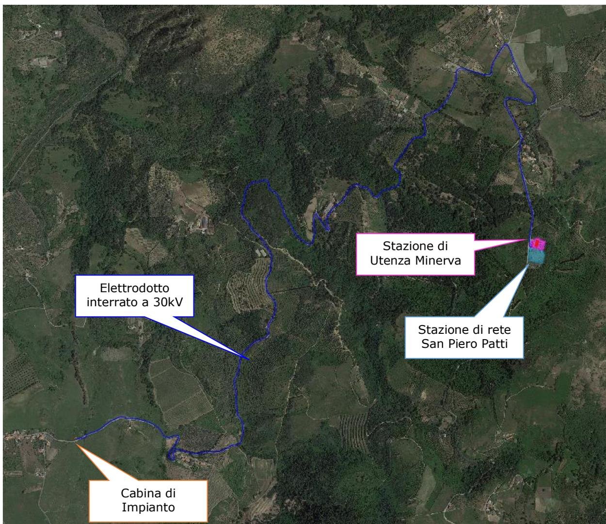
**Figura 1:** *Tracciato degli elettrodotti MT e AT*
