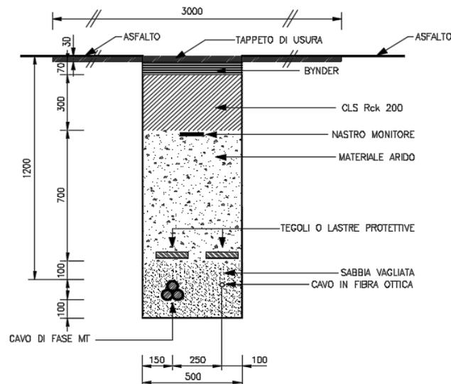
**Figura 4:** *Tipici di posa cavi MT con n°1 linee su viabilità asfaltata*
