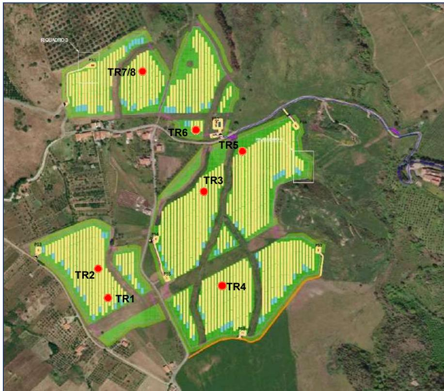
Acquisizioni sismiche effettuate in situ, denominate progressivamente da TR1 a TR8.
