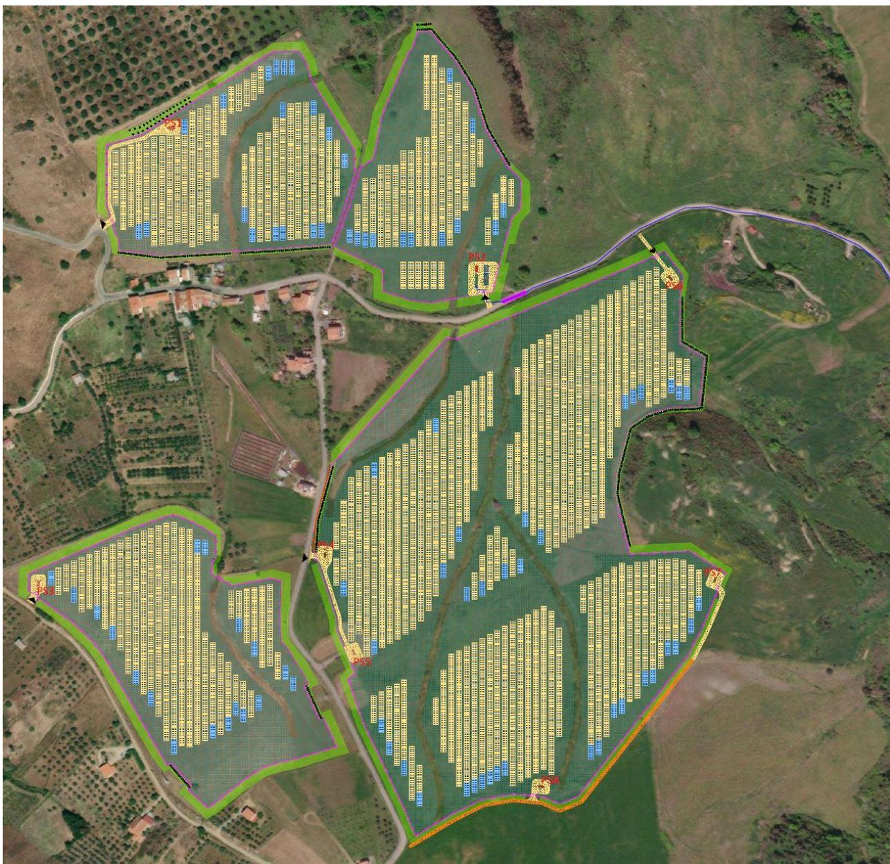
**Figura 6: Stralcio dell'elaborato "Inquadramento su base ortofoto" delle aree dove è prevista l'installazione dei pannelli fotovoltaici.**
