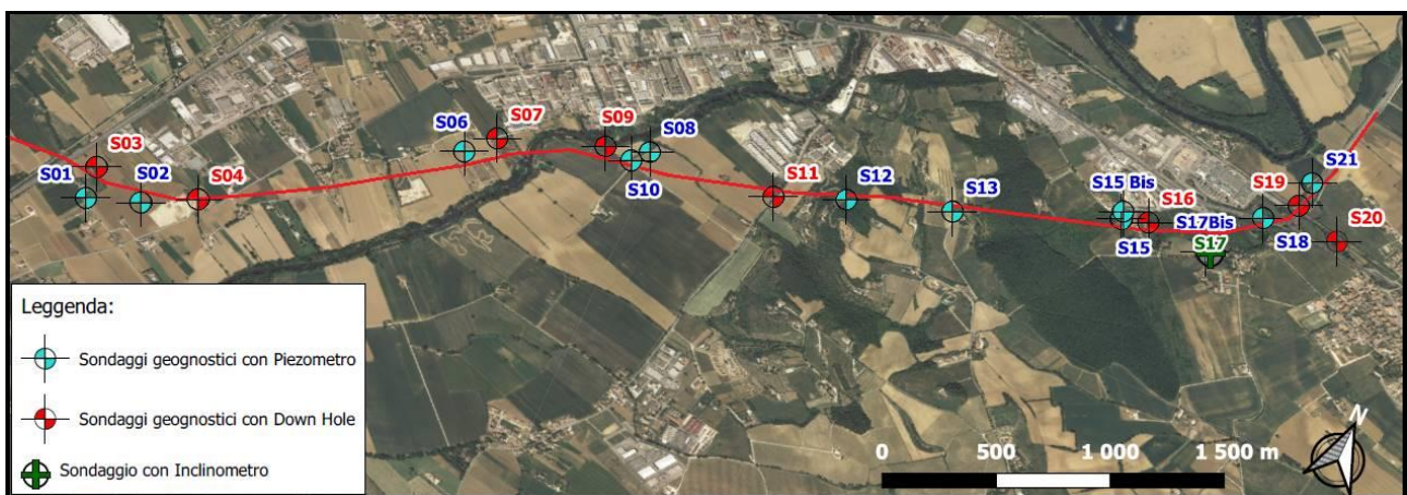
Figura 2.1 Ubicazione dei sondaggi a carotaggio continuo con indicazione del tracciato (linea rossa) (dalla relazione tecnica della Geo Gav, modificata).
