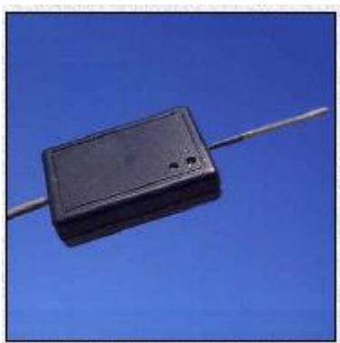
Figura 3.1 Trasduttore di spostamento (foto tipologica)
