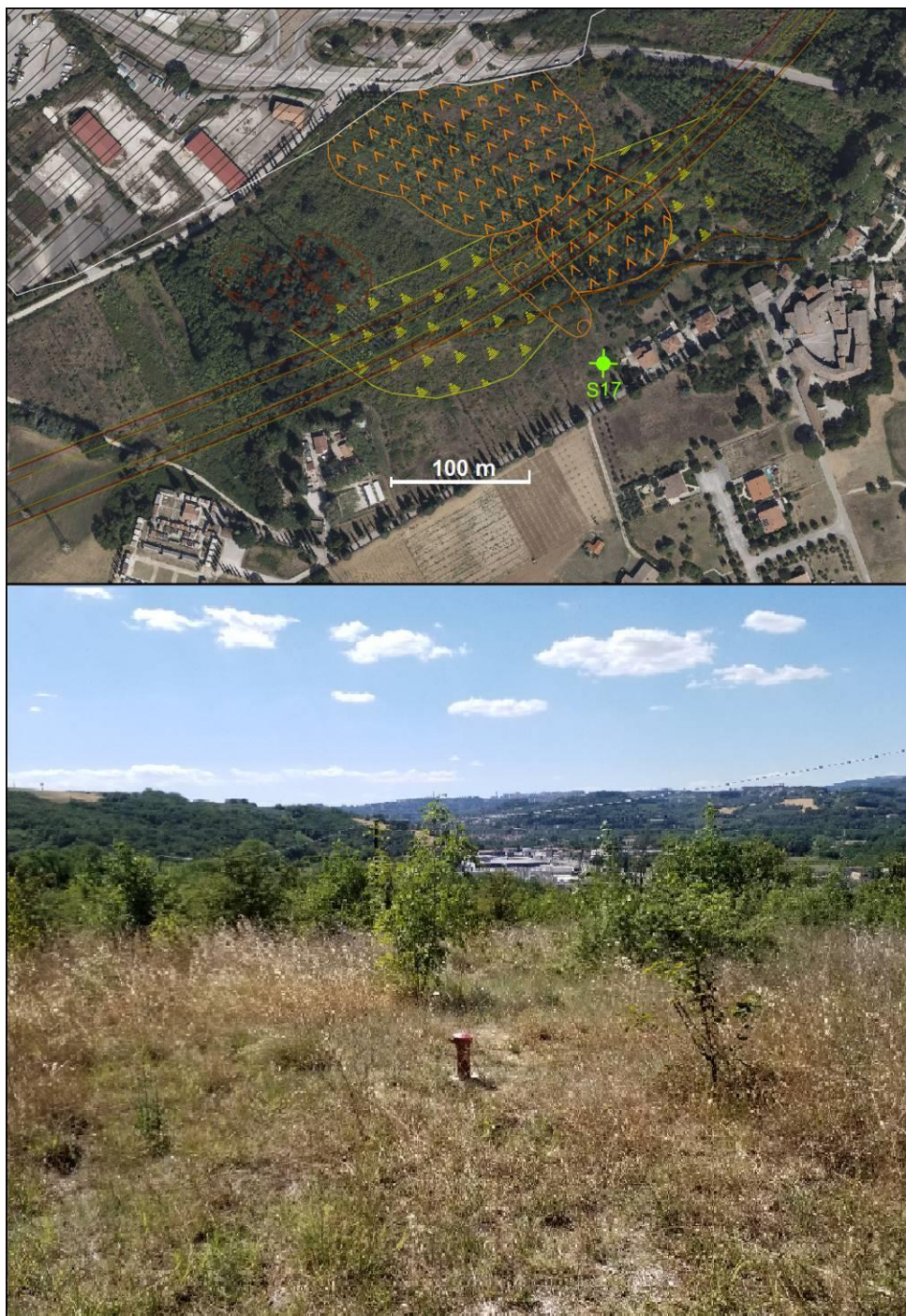
Figura 8.12 In alto: ubicazione dell'inclinometro (immagine satellitare da Google Earth) con indicazione del tracciato e dei tematismi geomorfologici individuati da rilevamento e dal PAI (riportati nella Carta geomorfologica). In basso: Pozzetto del tubo inclinometrico S17 presso la collina di Collestrada.
