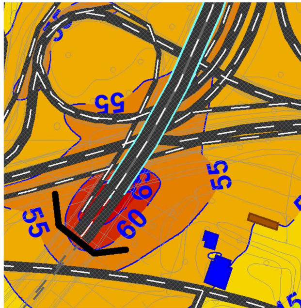
Figura 3.9 Effetto “colpo di fucile” all’imbocco nord-est della galleria
