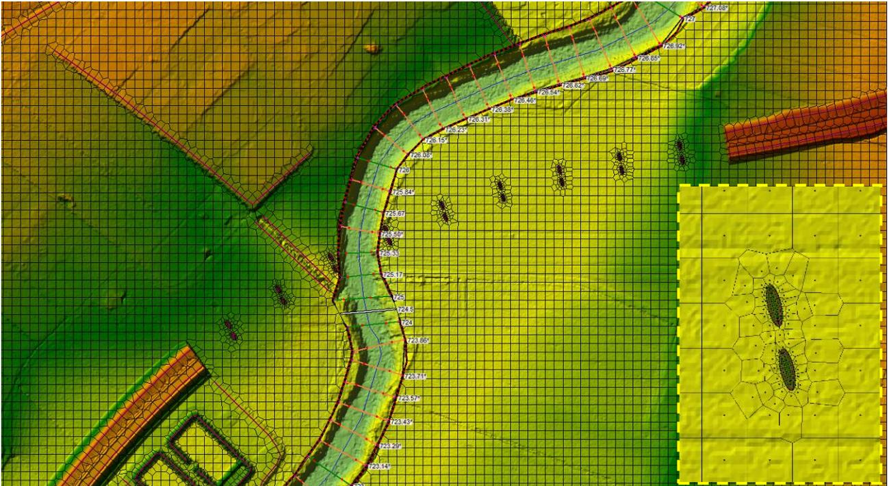
Figura 2-3: Dettaglio planimetrico della zona interessata dai viadotti affiancati di progetto, con un particolare della modellazione delle pile
