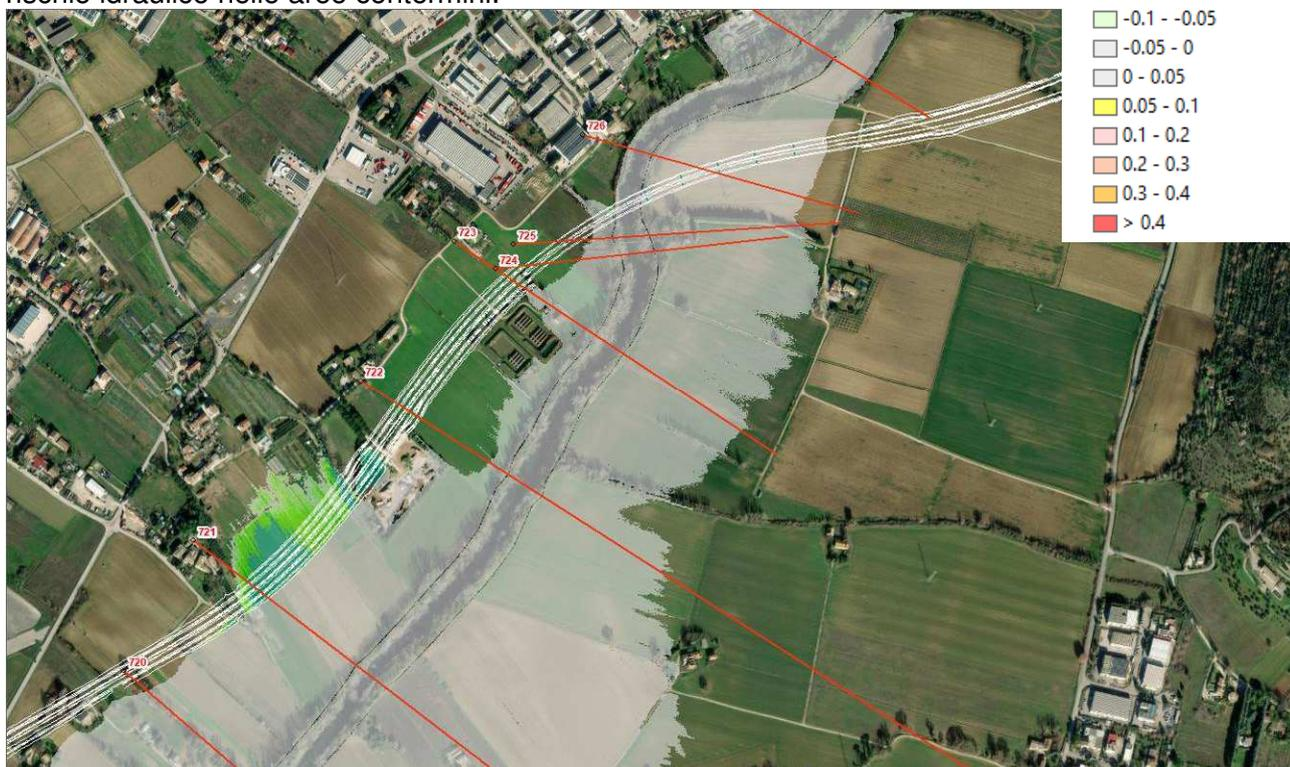
**Figura 5-16: Differenze tra i battenti locali duecentennali di progetto e attuali. Il colore grigio indica differenze contenute entro 3 cm (ricomprese nelle tolleranze di calcolo), il colore verde indica una riduzione di pericolosità idraulica.**
