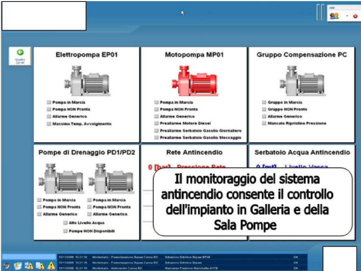
Fig. 8 – Sala pompe acqua antincendio – Su pagina separata viene rappresentato lo stato della rete idranti in galleria
