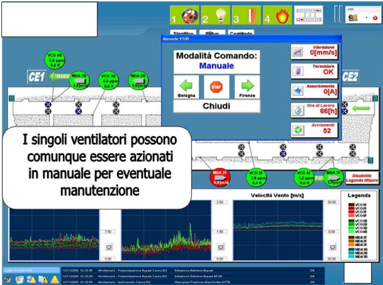
Fig. 6 - Pagina video per il sistema di ventilazione in galleria
