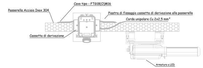
**CASSETTA IN ACCIAIO RESISTENTE AL FUOCO PER DERIVAZIONE LAMPADE Fuori scala**
