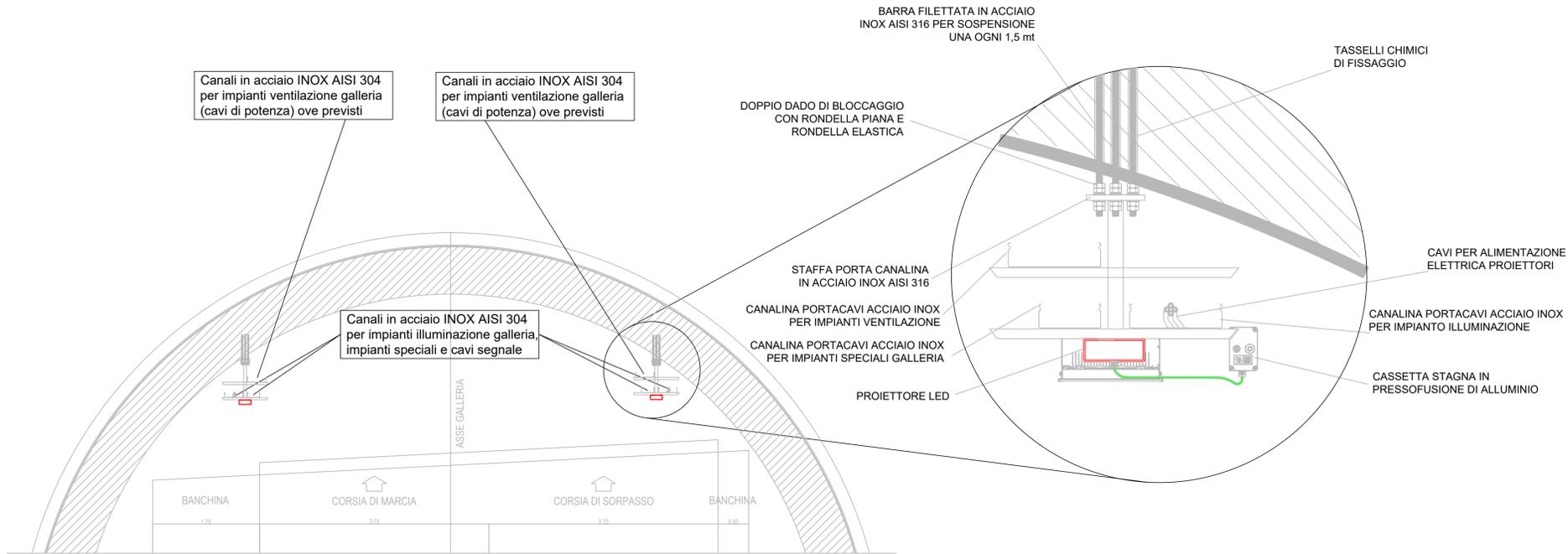
**VISTA LATERALE INSTALLAZIONE "TIPO" CASSETTA DI DERIVAZIONE SCALA 1:10**
