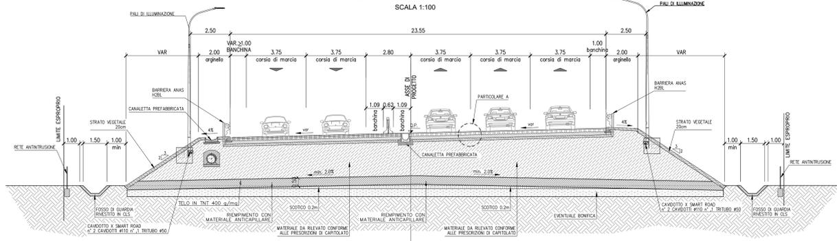
**SS75 ESISTENTE IN RETTIFILLO IN RILEVATO**
