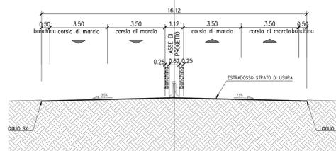
**SS75 ALLARGAMENTO PIATTAFORMA ESISTENTE IN RILEVATO**
