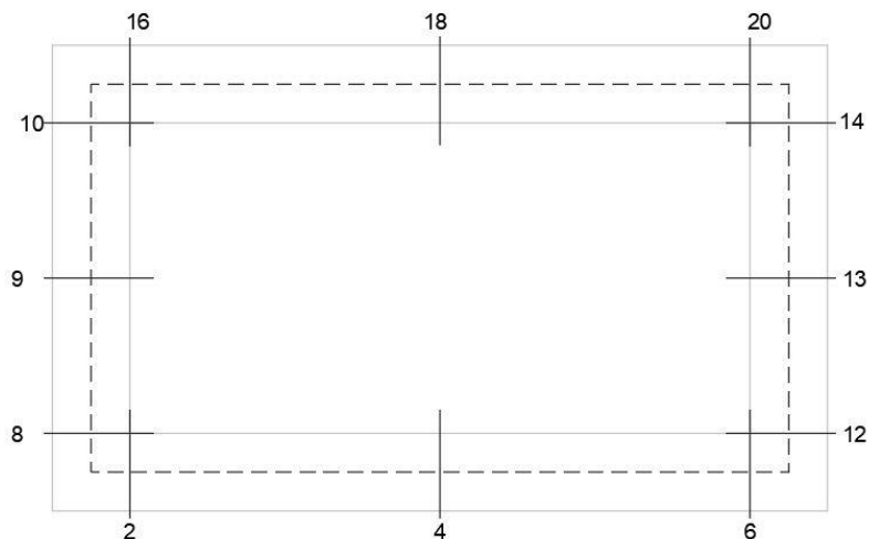
Figura 8.4: Sezioni considerate per la verifica di Momento e Taglio ai SL
