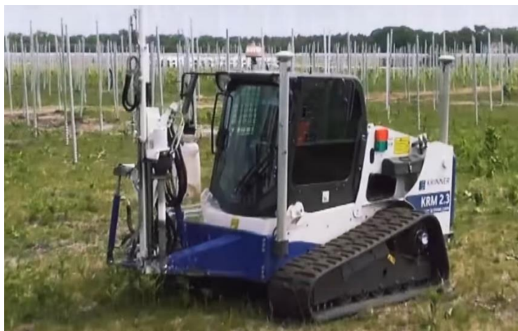
Fig. 2. Esempio di fissaggio delle strutture di supporto
