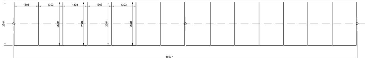
**SEZIONE LONGITUDINALE MODULO TRACKER DA 14 MODULI FV**
