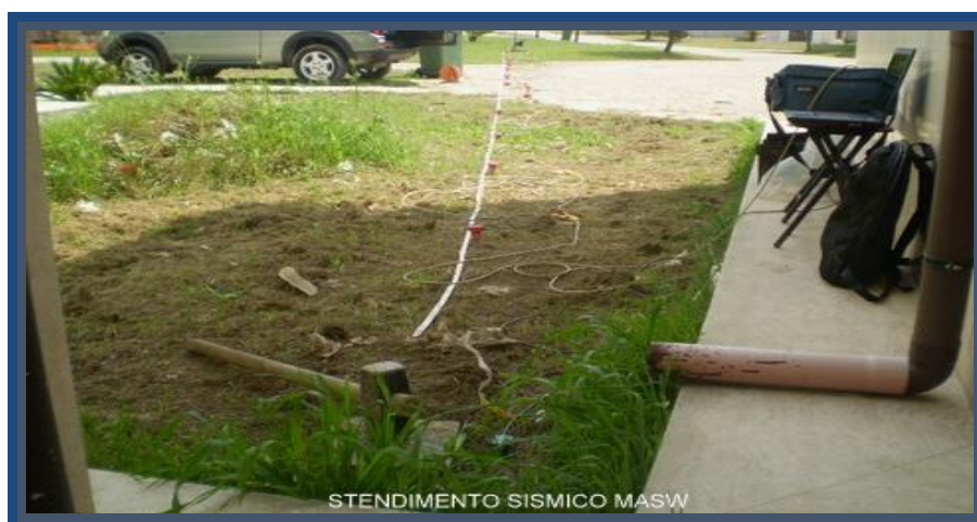
Figura 2: ESEMPIO DI STENDIMENTO SISMICO
