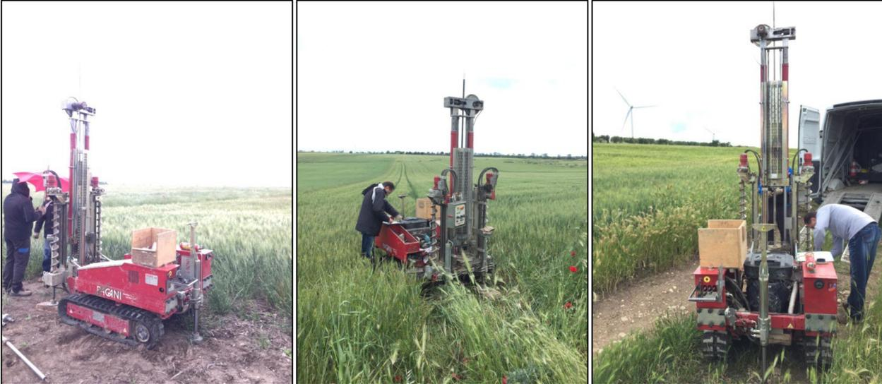
**Figura 8 – Foto dell'esecuzione delle prove penetrometriche DPSH1, DPSH2 e DPSH3.**
