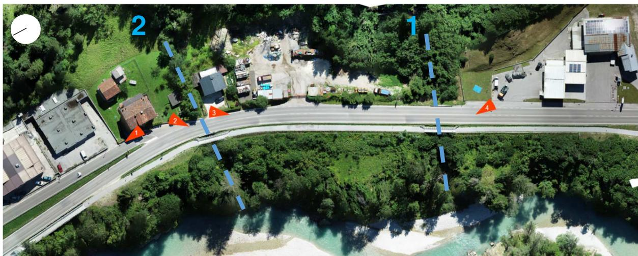
Figura 7 – Ortofoto con punti di scatto e indicazione tombini idraulici (a destra attraversamento 1, a sinistra attraversamento 2)
