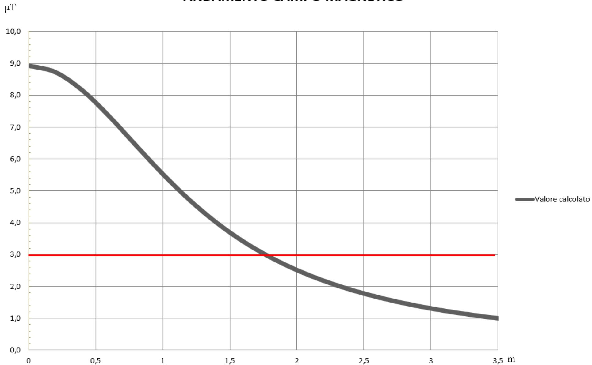
Valore dell'induzione magnetica al livello del suolo nel tratto da n° 2 terne da 300 mm<sup>2</sup> del cavidotto AT.
