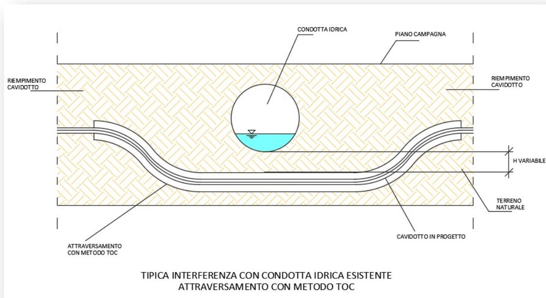
**Figura 21 - schema tipico di risoluzione interferenza con condotte idriche esistenti mediante l'utilizzo di metodo TOC**
