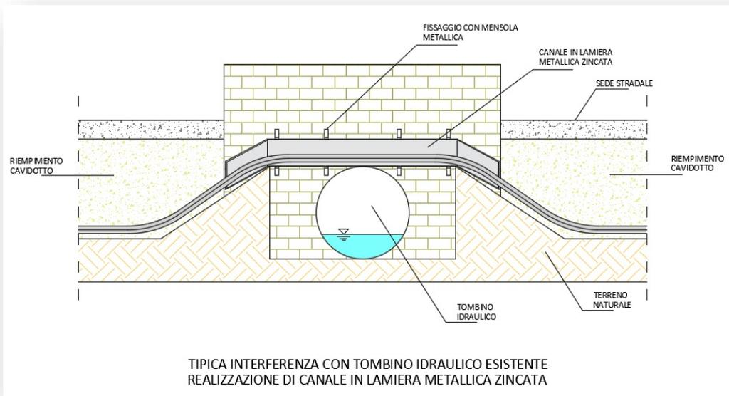
**Figura 19 - schema tipico di risoluzione interferenza con tombino idraulico mediante realizzazione di canale in lamiera metallica zincata**
