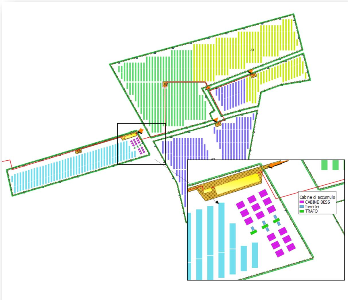
Figura 17 – Localizzazione impianto di accumulo
