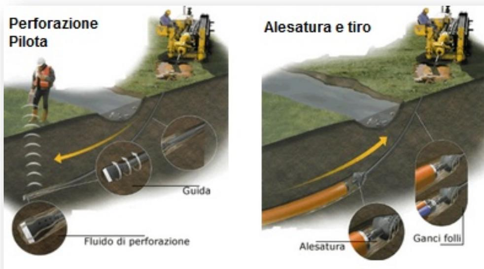
Figura 22 - tecnologia di trivellazione orizzontale controllata (TOC)
