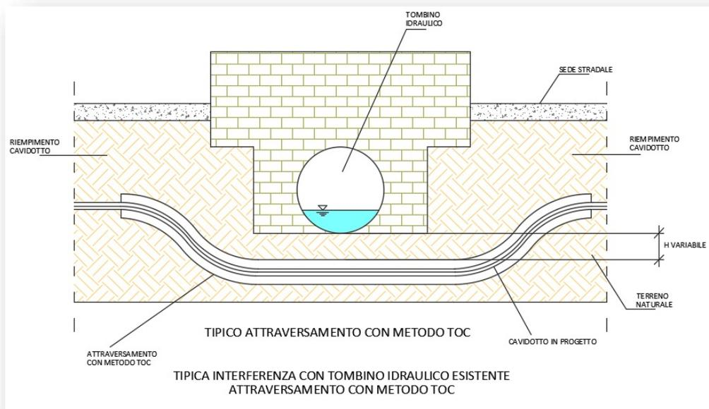
**Figura 20 - schema tipico di risoluzione interferenza con tombino idraulico mediante l' utilizzo di metodo TOC**
