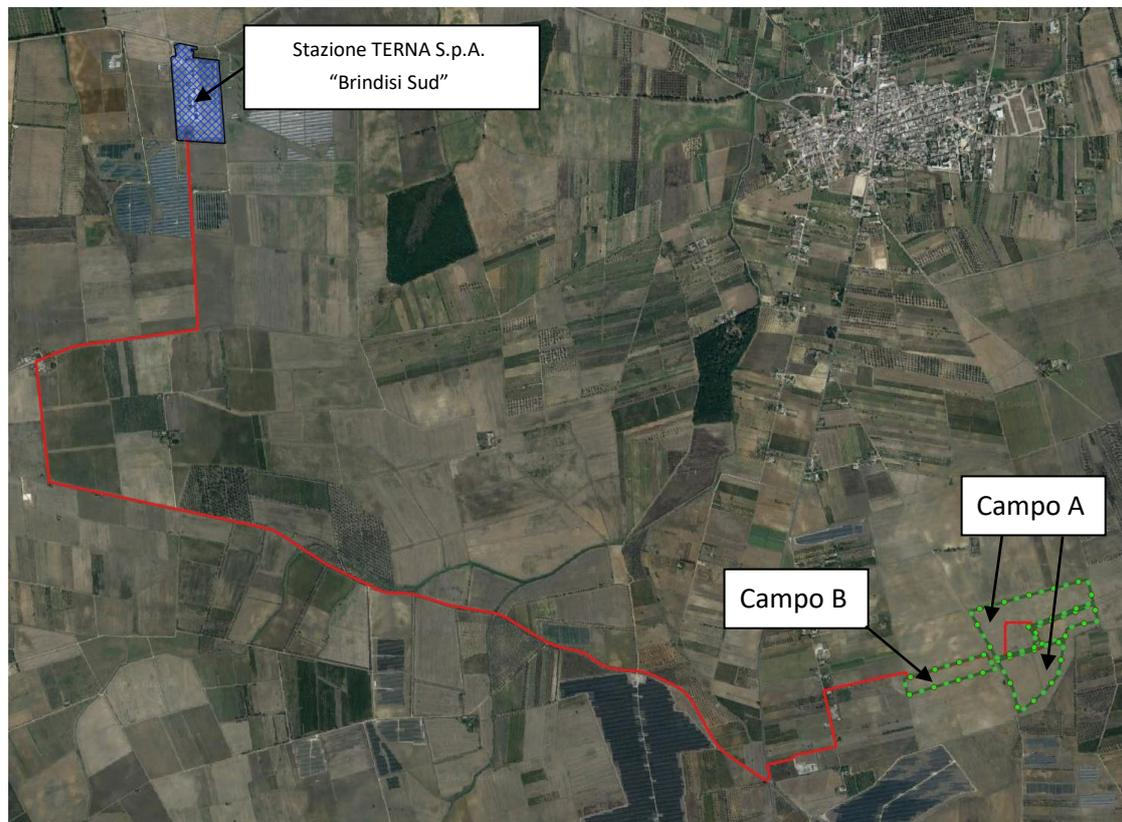
Figura 2 - Percorso dell'elettrodotto interrato AT da realizzare (tratto in rosso)
