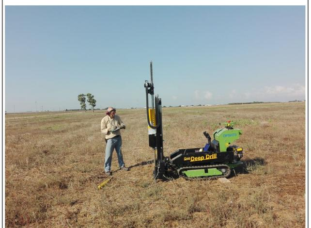
**DINAMIC PROBING SUPER HEAVY (DPSH n° 4)**Strumento utilizzato: **DPSH63-73 GEO DEEP DRILL (superpesante)**Prova eseguita in data: **18/03/2021**Profondità prova: **6,00 mt**Falda: **non rilevata**Certificato **Nr. 4 del 20/03/2021**Codice commessa nr. **30/2019GT CANADIAN-10B**Tipo elaborazione nr. colpi **Medio**
