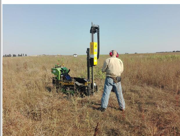
**DINAMIC PROBING SUPER HEAVY (DPSH n° 2)**Strumento utilizzato: **DPSH63-73 GEO DEEP DRILL (superpesante)**Prova eseguita in data: **18/03/2021**Profondità prova: **6,00 mt**Falda: **non rilevata**Certificato **Nr. 2 del 20/03/2021**Codice commessa nr. **30/2019GT CANADIAN-10A**Tipo elaborazione nr. colpi **Medio**
