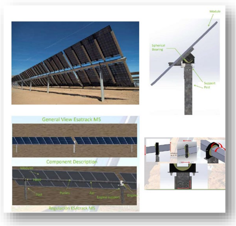
Figura 5 - Strutture di sostegno e sistema di inseguimento solare
