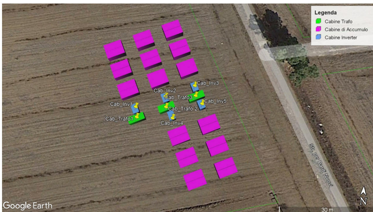
Figura 10 – Cabine Impianto di Accumulo
