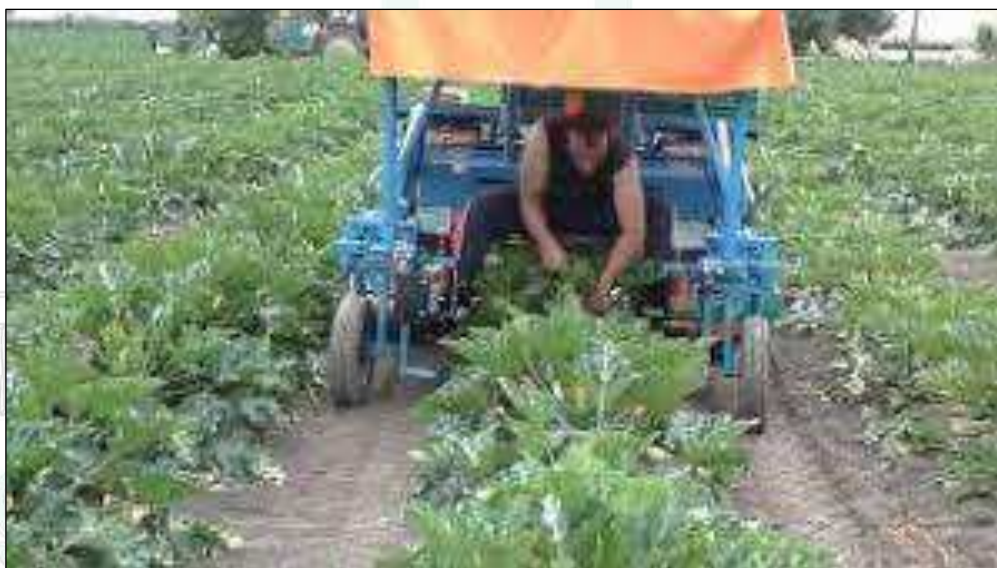
Tav.29 - Macchina agevolatrice per la raccolta del carciofo
