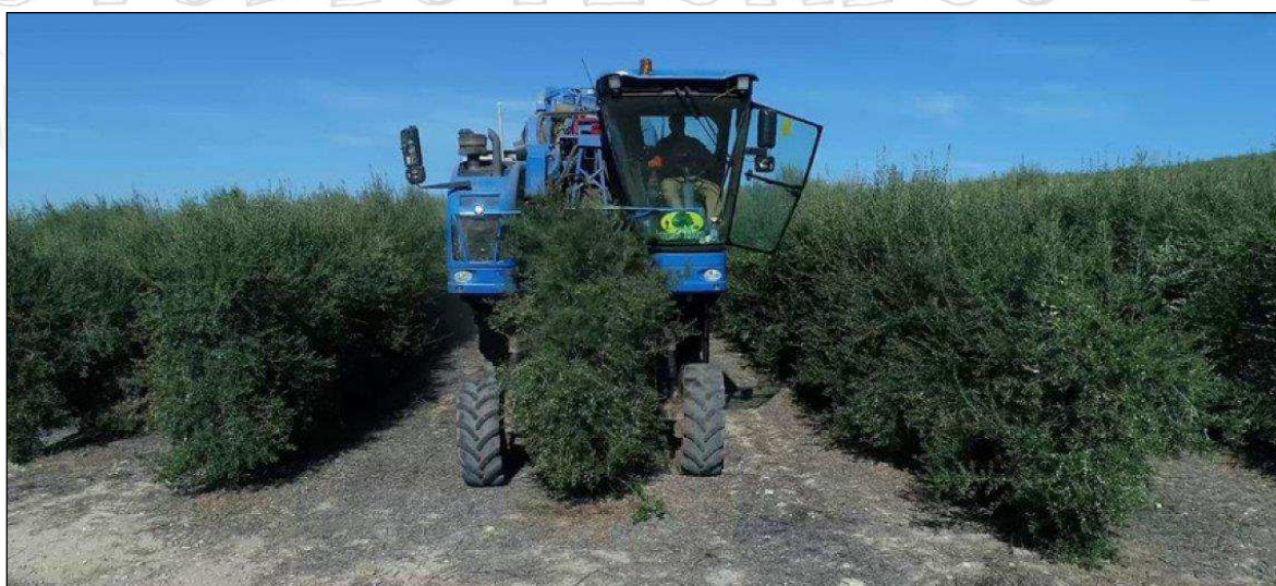
Figura 6 - Esempio di macchina scavallatrice durante la fase di raccolta
