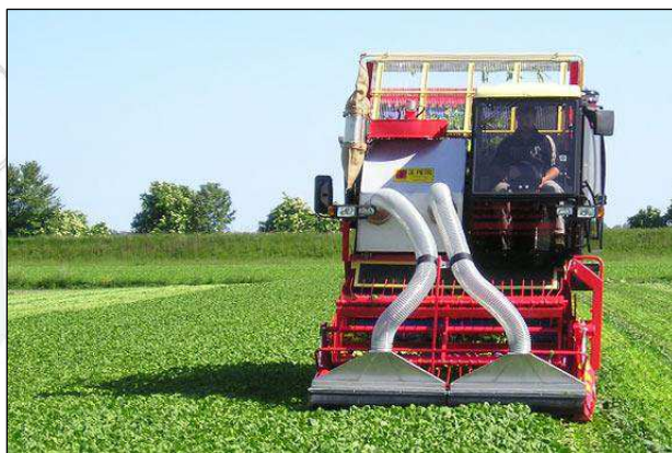
Fig.13 - Sistema di raccolta meccanizzato dello spinacio in pieno campo, vista frontale
