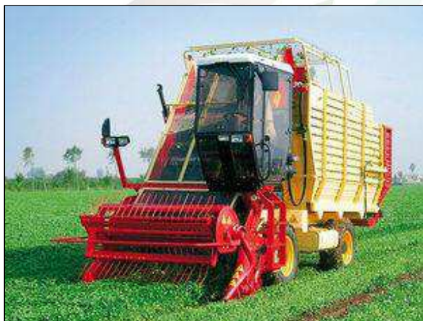
Fig.12 - Sistema di raccolta meccanizzato dello spinacio in pieno campo, vista laterale
