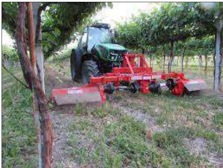
Figura 1 - Esempio di lavorazione con fresatrice bilaterale interceppo
