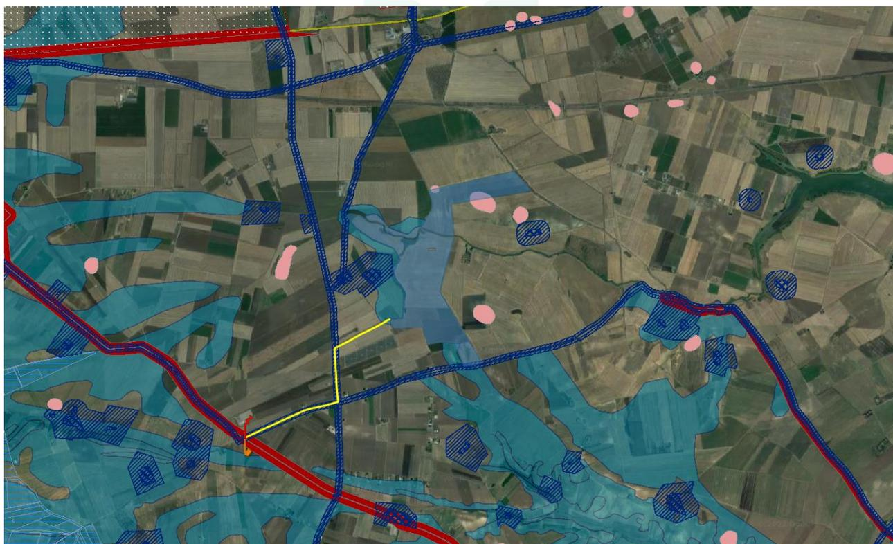
Figura 2-3: Interferenza progetto - struttura antropica e storico culturale PPTR, in blu la perimetrazione del sito, in giallo il tracciato della connessione MT, in rosso il tracciato AT e in arancione la SSE Utente
