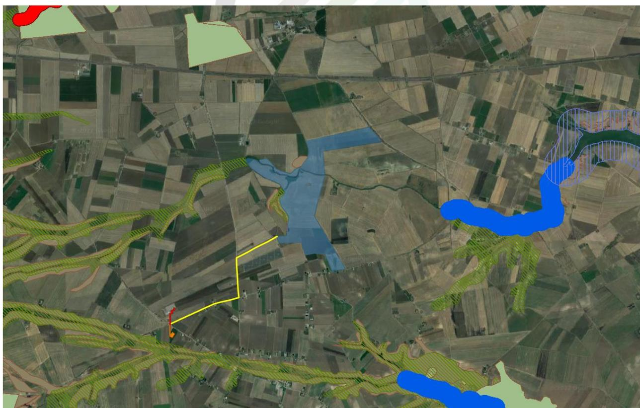
Figura 2-1: Interferenza progetto - struttura idro-geomorfologica PPTR, in blu la perimetrazione del sito, in giallo il tracciato della connessione MT, in rosso il tracciato della connessione AT e in arancione la SSE Utente
