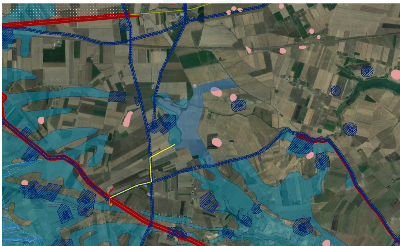
Figura 4-11: Interferenza progetto - struttura antropica e storico culturale PPTR, in blu la perimetrazione del sito, in giallo il tracciato della connessione MT, in rosso il tracciato AT e in arancione la SSE Utente
