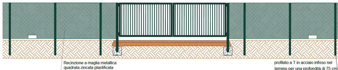
Ad integrazione della recinzione di nuova costruzione è prevista l'installazione di cancelli carrabili per un agevole accesso all'area d'impianto. Il cancello d'ingresso sarà realizzato in acciaio zincato, sorretto da pilastri in scatolare metallico. Le dimensioni saranno tali da permettere un agevole ingresso dei mezzi pesanti impiegati in fase di realizzazione e manutenzione. In fase esecutiva sarà considerata la possibilità di dotare il cancello di azionamento elettrico.
