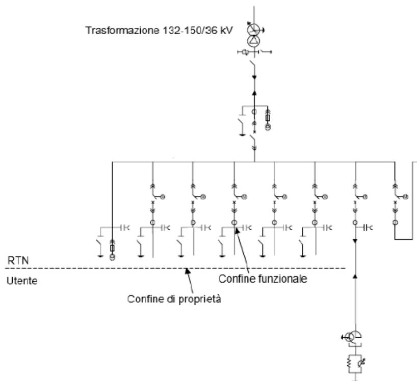
Figura 1 - Schema di connessione esemplificativo a 36 kV
