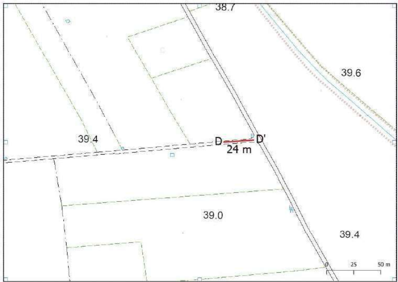
Figura 6.4: ubicazione dello stendimento sismico DD' su CTR della Regione Puglia
