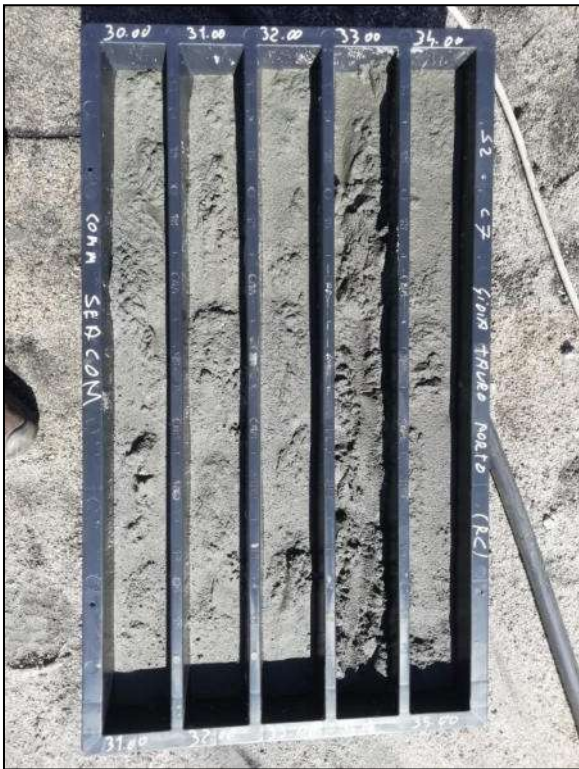
Foto 9 – Cassetta catalogatrice S2-C7 da 30,00 m a 35,00 m
