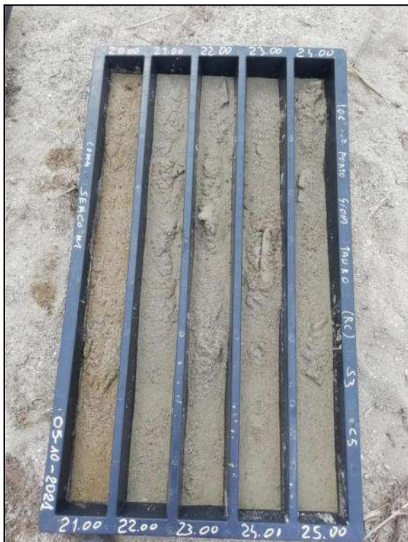
Foto 7 – Cassetta catalogatrice S3-C5 da 20,00 m a 25,00 m
