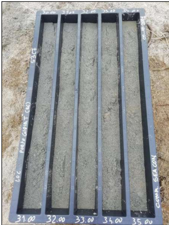
Foto 9 – Cassetta catalogatrice S3-C7 da 30,00 m a 35,00 m
