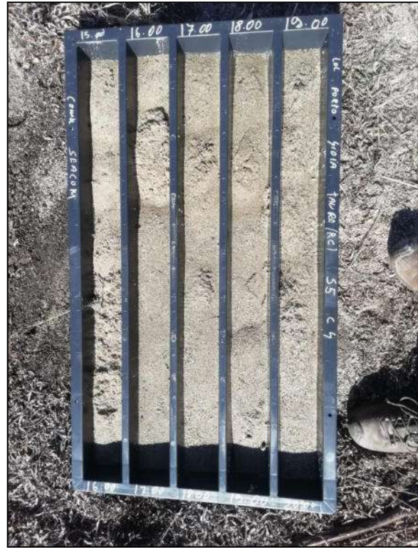
Foto 6 – Cassetta catalogatrice S5-C4 da 15,00 m a 20,00 m
