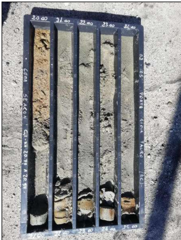
Foto 7 – Cassetta catalogatrice S2-C5 da 20,00 m a 25,00 m
