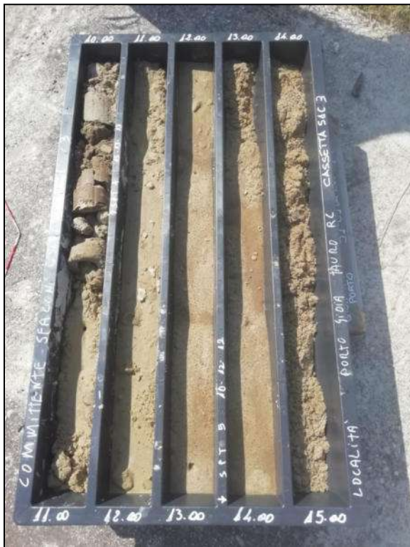
Foto 5 – Cassetta catalogatrice S1-C3 da 10,00 m a 15,00 m
