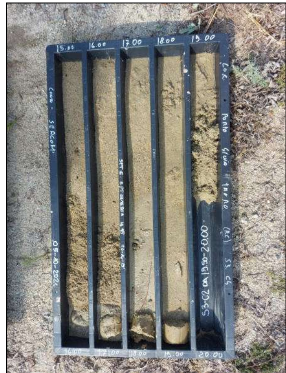
Foto 6 – Cassetta catalogatrice S3-C4 da 15,00 m a 20,00 m
