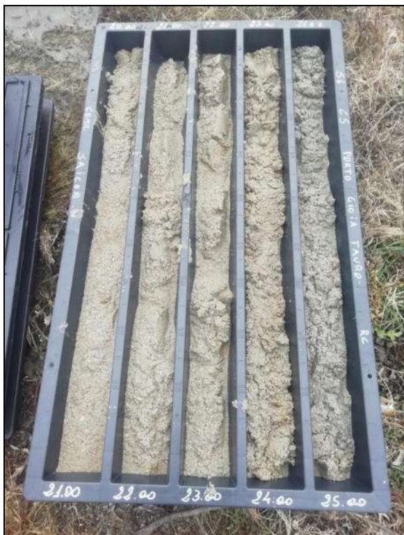
Foto 7 – Cassetta catalogatrice S6-C5 da 20,00 m a 25,00 m
