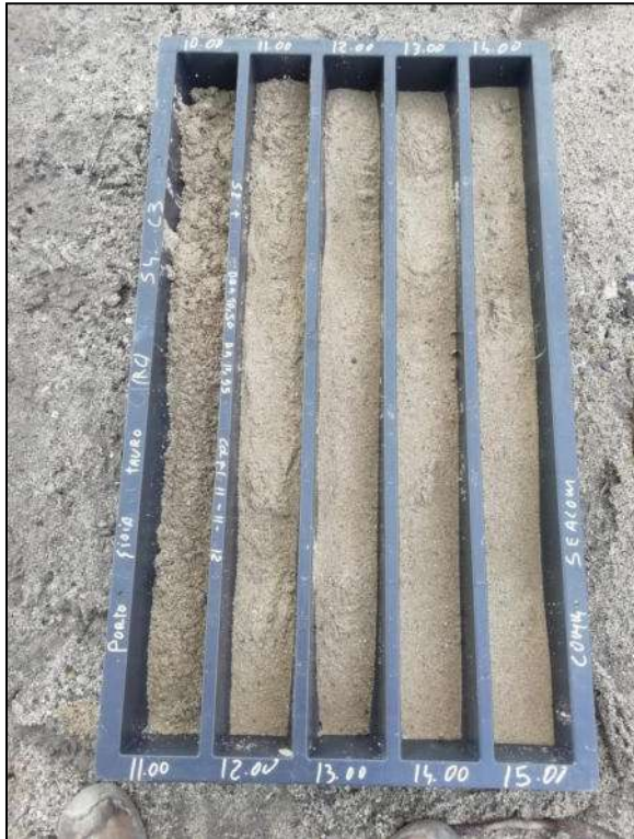
Foto 5 – Cassetta catalogatrice S4-C3 da 10,00 m a 15,00 m
