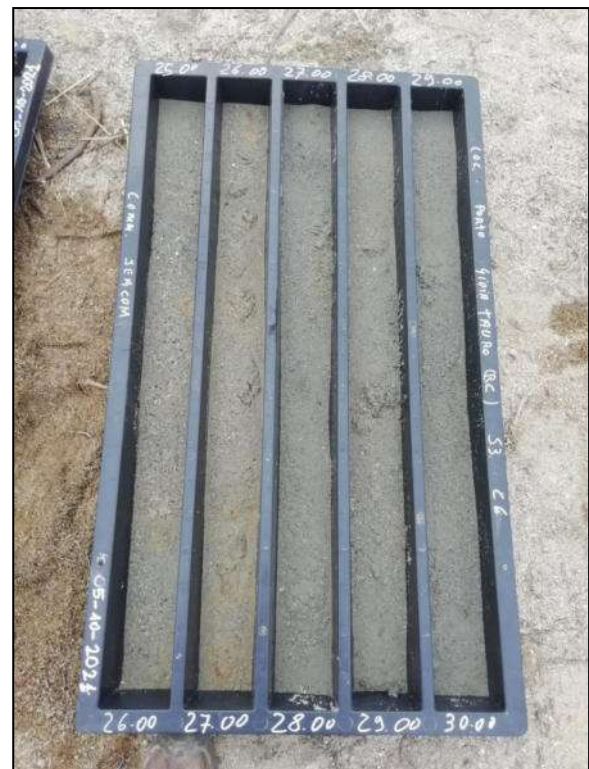
Foto 8 – Cassetta catalogatrice S3-C6 da 25,00 m a 30,00 m
