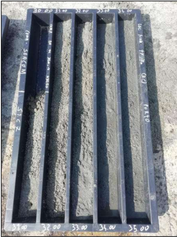
Foto 9 – Cassetta catalogatrice S1-C7 da 30,00 m a 35,00 m
