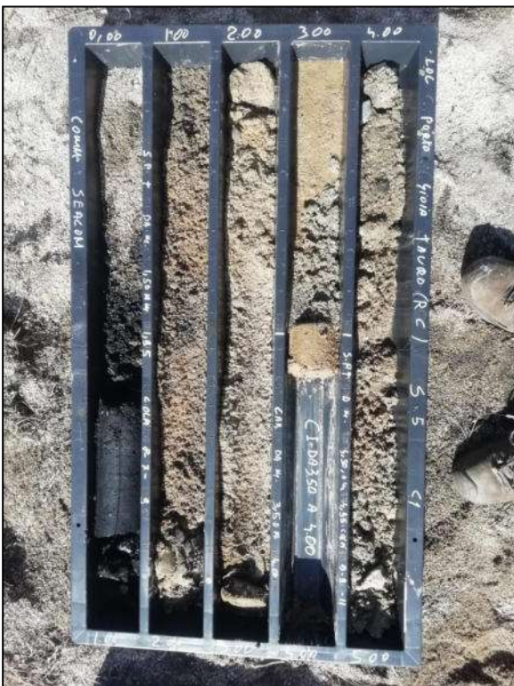
Foto 3 – Cassetta catalogatrice S5-C1 da 0,00 m a 5,00 m
