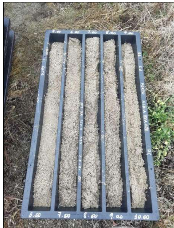
Foto 4 – Cassetta catalogatrice S6-C2 da 5,00 m a 10,00 m
