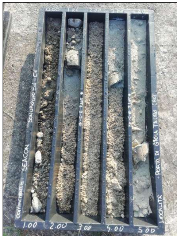
Foto 3 – Cassetta catalogatrice S1-C1 da 0,00 m a 5,00 m
