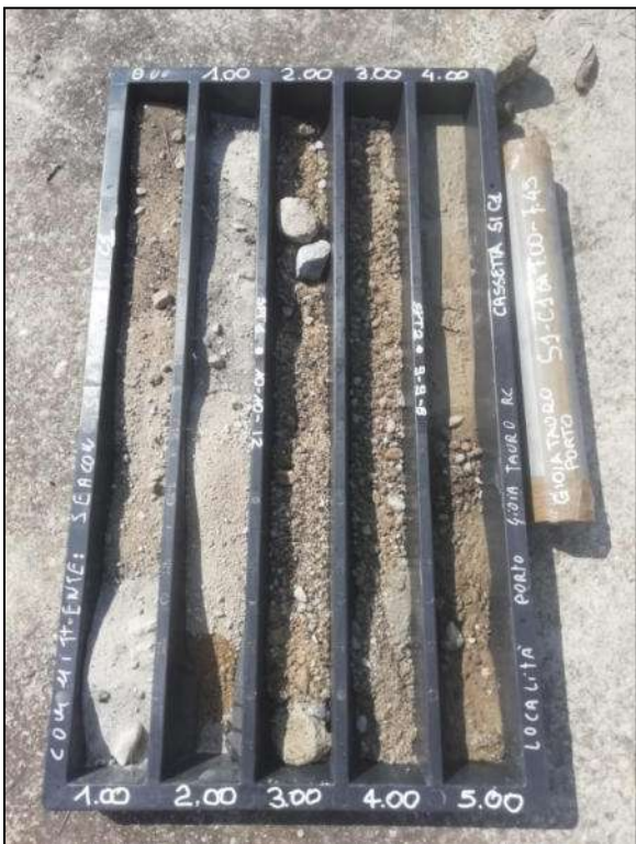
Foto 3 – Cassetta catalogatrice S1-C1 da 0,00 m a 5,00 m
