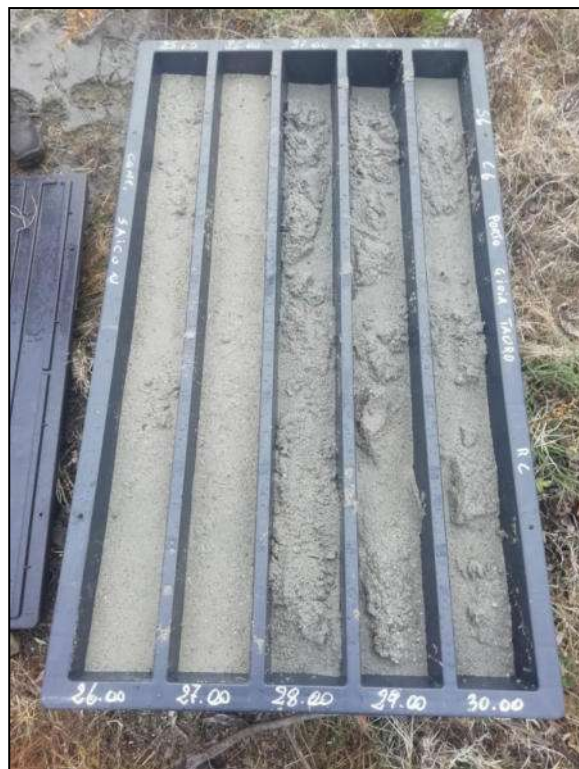
Foto 8 – Cassetta catalogatrice S6-C6 da 25,00 m a 30,00 m
