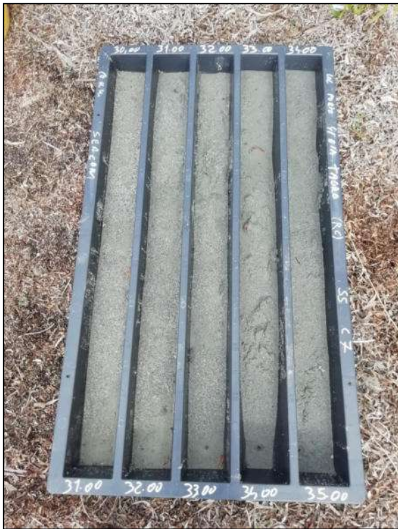
Foto 9 – Cassetta catalogatrice S5-C7 da 30,00 m a 35,00 m
