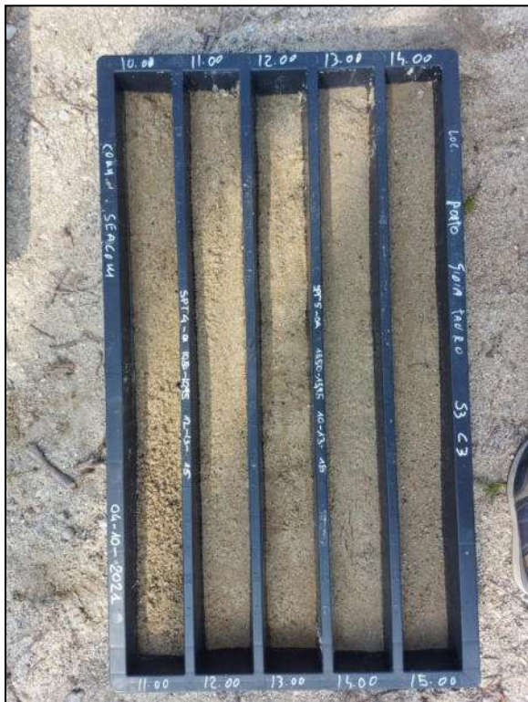
Foto 5 – Cassetta catalogatrice S3-C3 da 10,00 m a 15,00 m
