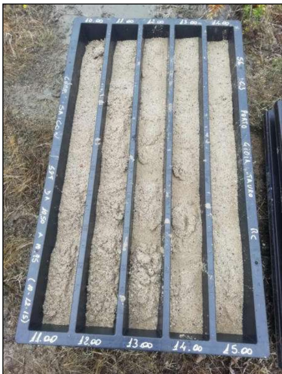
Foto 5 – Cassetta catalogatrice S6-C3 da 10,00 m a 15,00 m
