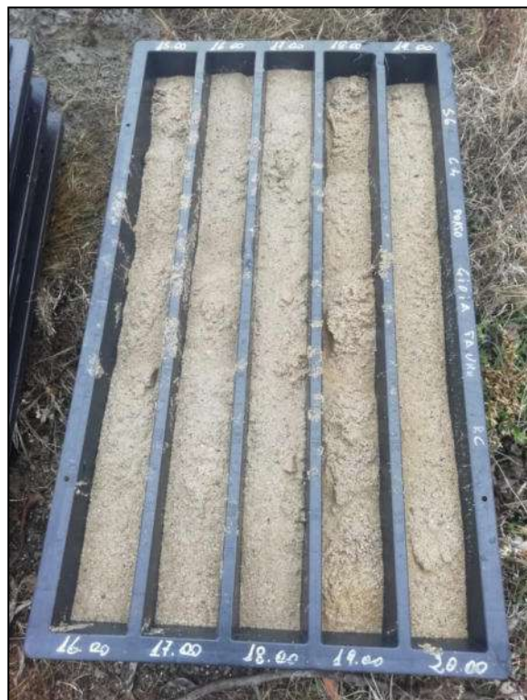
Foto 6 – Cassetta catalogatrice S6-C4 da 15,00 m a 20,00 m
