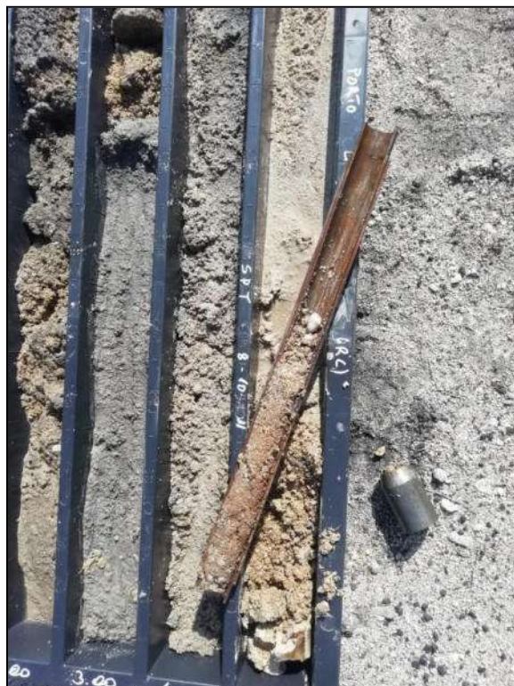
Foto 11 – Fase di scarotaggio della punta S.P.T. aperta
