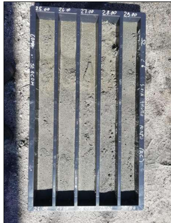
Foto 8 – Cassetta catalogatrice S2-C6 da 25,00 m a 30,00 m
