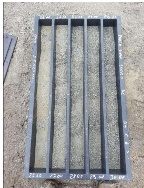
Foto 8 – Cassetta catalogatrice S4-C6 da 25,00 m a 30,00 m
