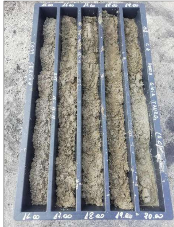
Foto 6 – Cassetta catalogatrice S2-C4 da 15,00 m a 20,00 m
