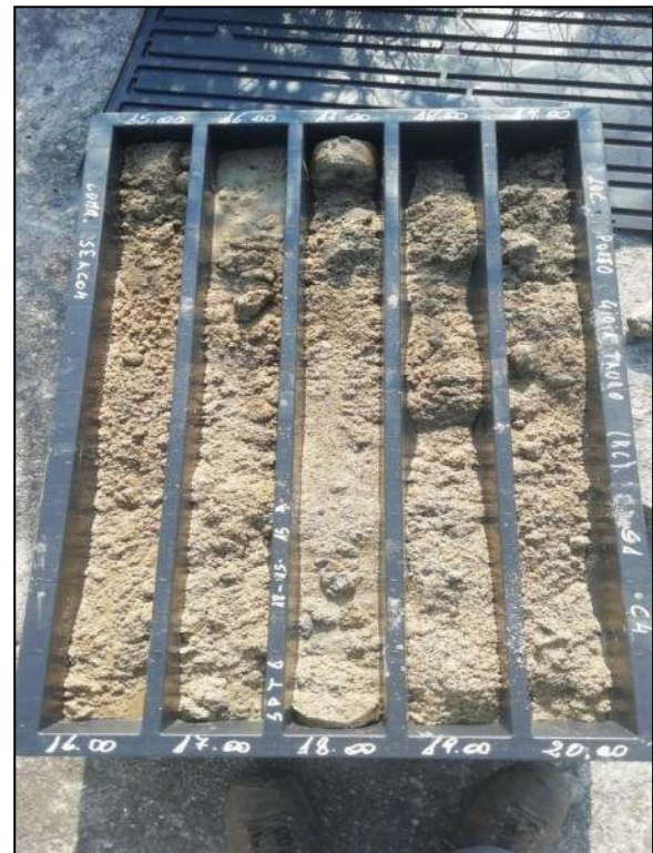
Foto 6 – Cassetta catalogatrice S1-C4 da 15,00 m a 20,00 m
