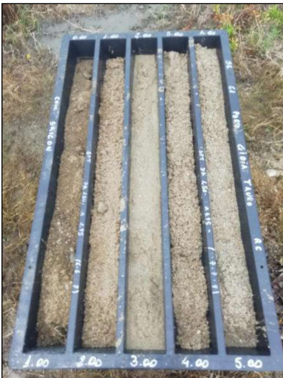
Foto 3 – Cassetta catalogatrice S6-C1 da 0,00 m a 5,00 m
