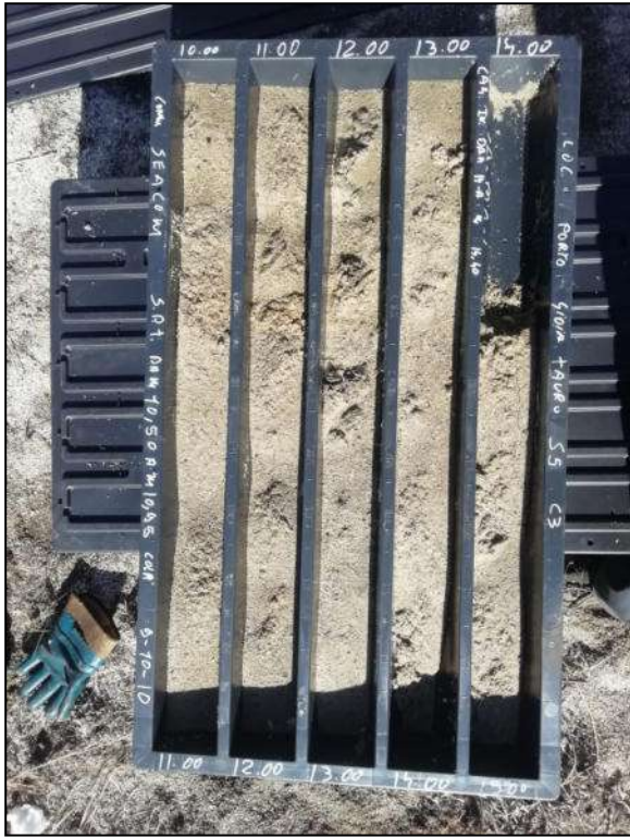
Foto 5 – Cassetta catalogatrice S5-C3 da 10,00 m a 15,00 m
