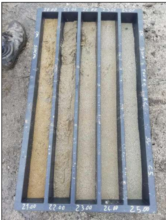
Foto 7 – Cassetta catalogatrice S4-C5 da 20,00 m a 25,00 m
