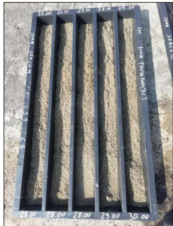
Foto 8 – Cassetta catalogatrice S1-C6 da 25,00 m a 30,00 m
