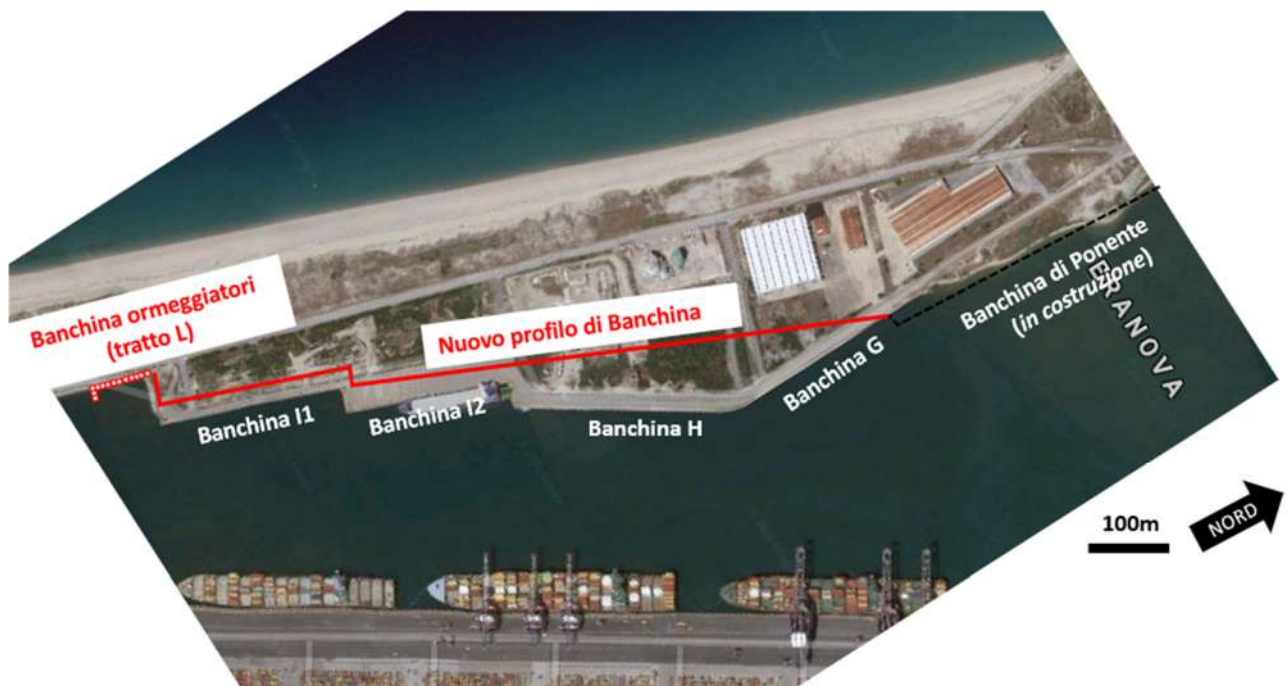
Figura 4 - Fotografia aerea dell'area di intervento con sovrapposizione degli allineamenti
