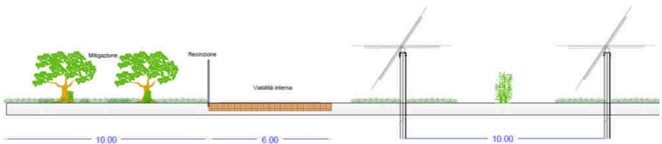
Fascia di mitigazione perimetrale (sezione)
