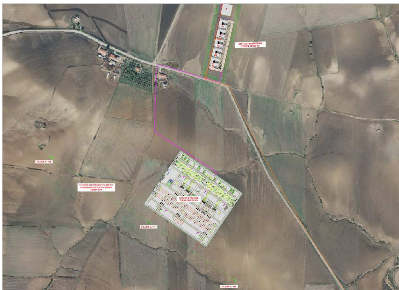
Planimetria generale della SSE e delle opere di connessione alla RTN su Ortofoto (FR-AIDONE-AFV-PD-D-5.1.3.0-r0A-R00)
