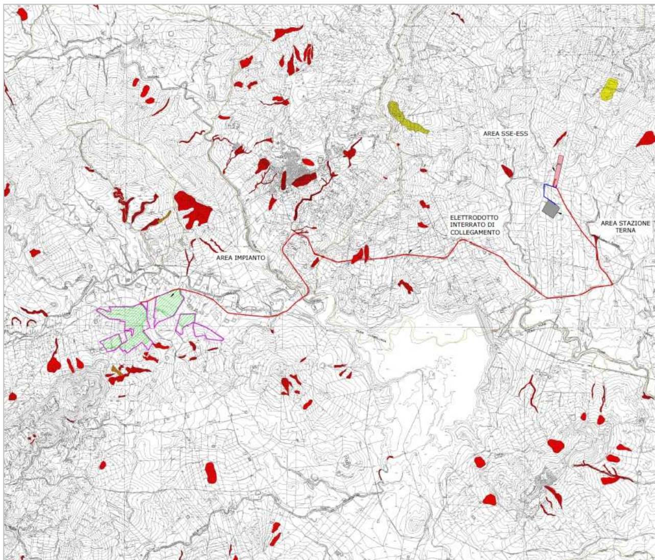
Estratto tavola PAI – Dissesti con sovrapposte le aree di impianto (tav. FR-AIDONE-AFV-PD-D-2.3.2.0-r0A-R00)
