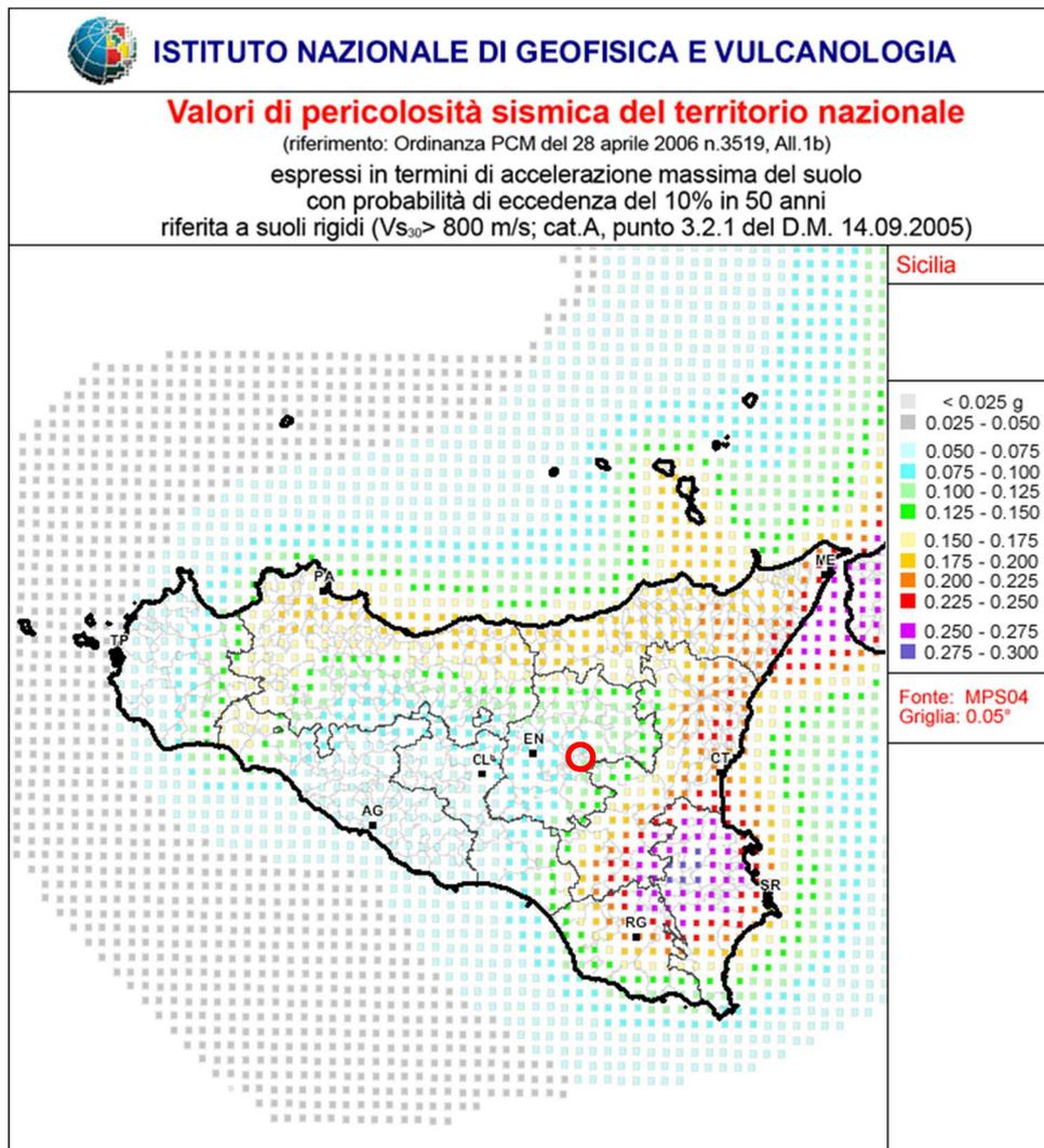
Mappa della pericolosità sismica (<http://zonesismiche.mi.ingv.it>)
