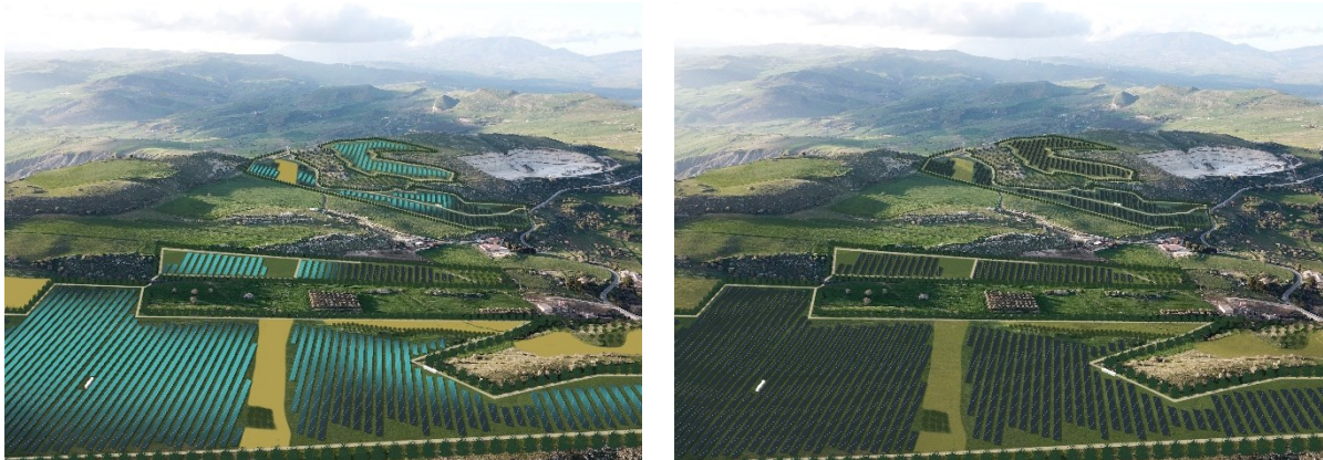
Figura 42 - Rendering dell'impianto "GARISI" con moduli in silicio policristallino (foto a sinistra) e con moduli con tecnologia antiriflesso in silicio monocristallino (foto a destra - soluzione adottata)
