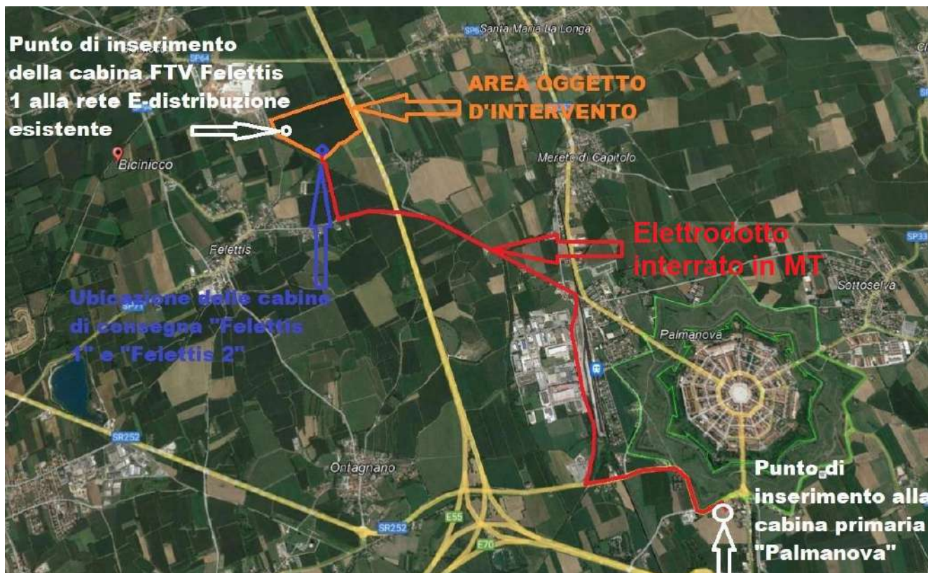
Vista d'insieme dell'impianto di connessione con collegamento cavi MT interrati (in rosso) su base ortofoto
